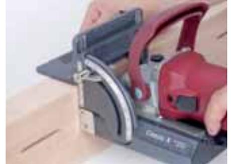
**Variable Einstellung der Nutposition** von der Anschlagfläche 0–50 mm
