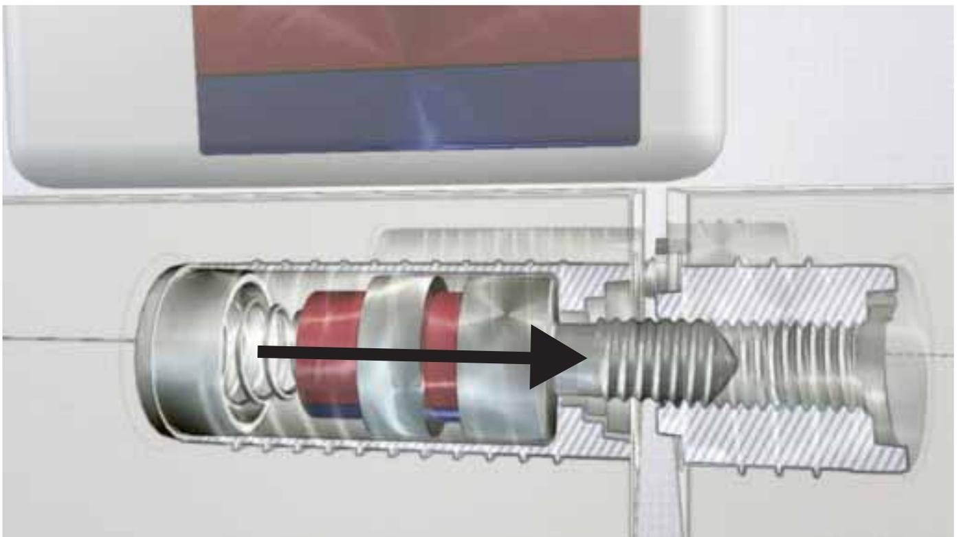
Der Antrieb MiniMag Mx2 schliesst oder öffnet die Verbindung
