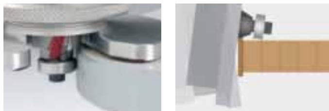
Die Aussparung für vorstehende Kanten erlaubt das Führen der Maschine auf der Fläche in vertikaler Position und verhindert so das Verwackeln.
