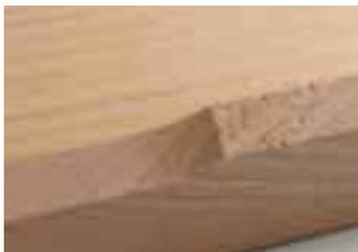
Ausrissfreies Arbeiten im Querholz
