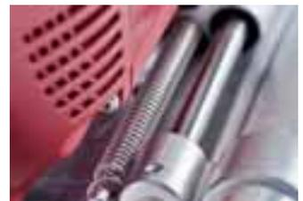
Leichtgängige Säulenführung, Grundplatte wird durch die starke Feder blitzschnell zurückgezogen
