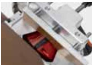
Parallelanschlag für beschichtete Platten
