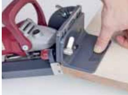
**Perfekte Präzision der Gehrungen** durch Anschlag an der Aussenfläche für 22.5 und 45° Winkel
