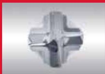
Aufgrund der optimalen 4x90° Symmetrie arbeiten alle HM-Schneiden gleichmäßig und haken bei Armierungseisen nicht ein.
