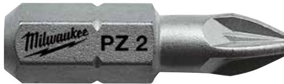
Milwaukee® Schrauberbits werden in einem speziellen Verfahren mit Temperaturen von bis zu 870°C ausgehärtet. Auf diese Weise entsteht ein harter Schrauberbit mit einer besonders langlebigen Bit-Spitze.
