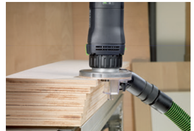
Fasefräsen von Kunststoff- oder Massivholz-umleimern.
