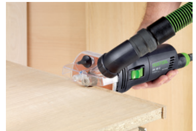
Bündigfräsen von Kunststoff- oder Massivholz-umleimern.
