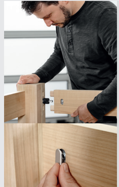
Die Eckverbinder: Nicht nur extrem schnell und extrem stabil, sondern auch mit hochwertiger Optik: Einzig sichtbar ist die Abdeckkappe, die über das ovale, DOMINO-typische Fräsloch geklipst wird.
