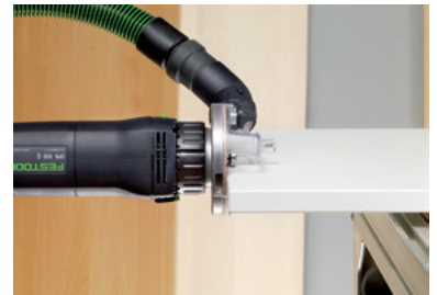
Abrunden von Kunststoff- oder Massivholz-umleimern.
