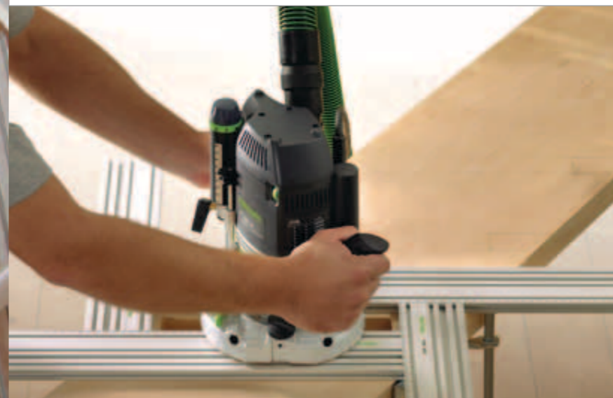
Einmal einstellen, in Serie arbeiten: Mit der Multifrässhablone MFS und der Oberfräse OF 2200 sind Treppenwangen schnell gefräst.
