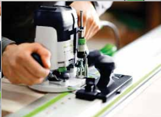
Gerade Fräsen in der Fläche – für das Fräsen einer Rückwandnut in der Fläche ist die Führungsschiene wie geschaffen.
