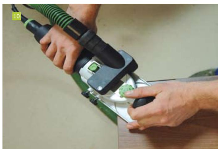
Die Kunststoffbacken des Anschlages werden so weit auseinander gezogen, bis sich der Fräser frei dazwischen drehen kann. Beim Fräsen muss man darauf achten, dass man Außenkonturen gegen den Uhrzeigersinn und Innenkonturen im Uhrzeigersinn fräst (Bild 6).
