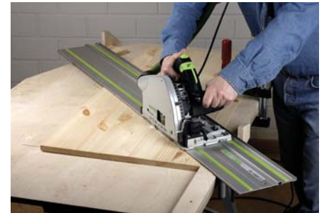
... der Tischfläche befestigen (kleines Foto o. re.). Das hintere Anschlagbrettchen lässt sich an der hinteren Tischkante beliebig verschieben und z.B. mit einer Zwinne fixieren. So sind auch schräge Zuschnitte problemlos möglich.
