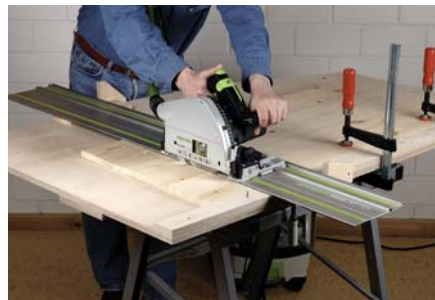
Das Werkstück einfach auf die Tischfläche und gegen die Anschlagleiste legen und mit Zwingen fixieren. Anschließend die Sägeschiene auflegen und gegen die Anschlagbrettchen stoßen. Die Schiene mit den beiden Spezialzwingen unter ...
