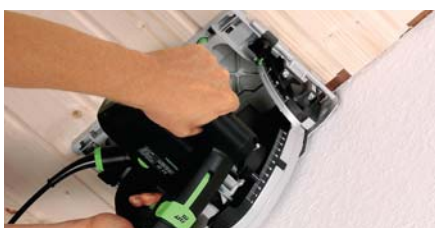
Mit dem Schattenfugenanschlag können Deckenvertäfelungen mit 18 mm schmalen Schattenfugen versehen werden. Da die Schattenfuge erst nach der Deckenmontage gesägt wird, müssen die Bretter nicht schon vorher auf ein genaues Längenmaß zugeschnitten werden, das erledigt dann die Tauchsäge.
