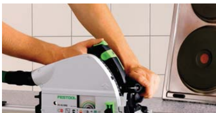
Im Küchenbau ist die Tauchfunktion besonders beim Einlassen von Kochfeldern und Spülen eine große Hilfe. Ohne langwierige Messarbeiten können hier - in Kombination mit der Führungsschiene - schnurgerade und ausrissfreie Schnitte auch in sehr empfindlichen Arbeitsplatten hergestellt werden.
