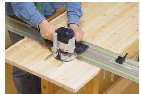
Führungsschiene: Im Gegensatz zum Parallelanschlag bietet sie eine freie Positionierung auf dem Werkstück und eine zwangsgeführte Oberfräse.
