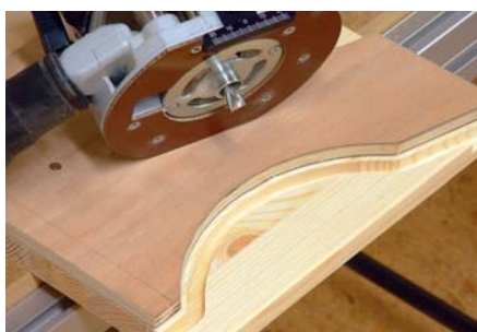
Kopierhülse: Geschweifte Schablonen können mit einer Kopierhülse "abgefahren" werden. Dadurch sind beliebig viele perfekte Kopien möglich.
