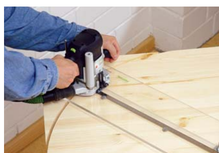
Zirkleinrichtung: Runde oder auch halbrunde Tischplatten sind mit einer Zirkleinrichtung in wenigen Minuten hergestellt.
