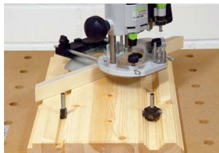
Parallelanschlag: Bei Nut- und Profilfräsern ohne Kugellager wird die Fräse mittels Parallelanschlag oder einer Führungsschiene "auf Kurs" gehalten.
