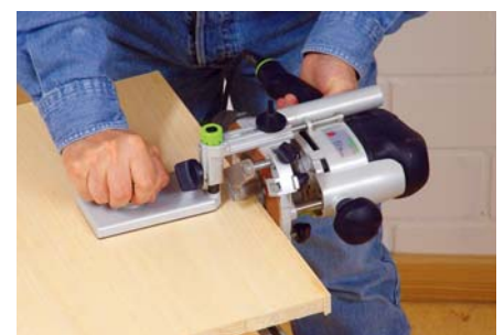
Anleimer bündig fräsen: Was sonst mit dem Handhobel vorsichtig bündig gehobelt werden muss, erledigt hier die Fräse sicher und absolut präzise.
