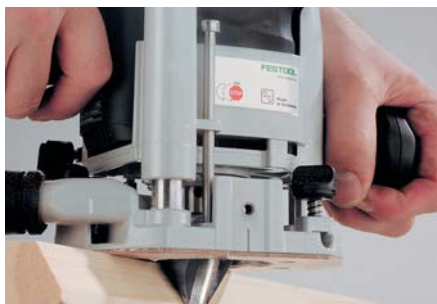
Kugellager: Holzkanten abrunden, fassen oder profilieren ist mit einem Kantenfräser mit Kugellager ein Kinderspiel und gelingt auch dem Anfänger.
