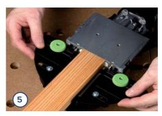
Legen Sie eine Zarge in den Leistenanschlag und vermitteln Sie sie. Anschließend schieben Sie die beiden Anschläge gegen die Holzkanten und ziehen die ...
