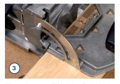
Eine weitere Möglichkeit ist die Positionierung über die im Anschlag befindliche Skala, die immer genau die Mitte des Domino Dübels anzeigt. Dies ist besonders bei Rahmenverbindungen sehr hilfreich
