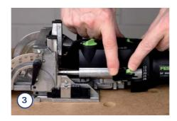
Die Frästiefe wird an der Seite der Fräse eingestellt. Dazu muss der schwarze Entriegelungsknopf gedrückt werden, bevor der grüne Schieber auf die gewünschte Tiefe eingestellt werden kann.
