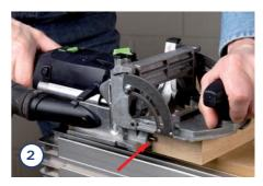
Wem das zu ungenau erscheint, der nutzt einfach die beiden versenkbaren Anschlagstifte, die er nur an die Außenkanten des Werkstücks anlegen muss (Pfeil).
