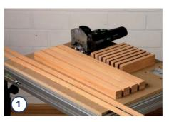
Pfosten und Zargen müssen genau rechtwinklig gehobelt werden, damit später alles perfekt zusammenpasst. Falls Sie keine eigene Hobelmaschine besitzen, dann lassen Sie sich das Material am besten vom Schreiner hobeln.
