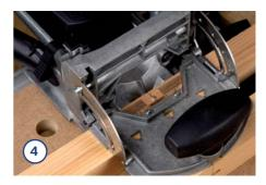
... Anschlag. Richten Sie anschließend die Skalenzentrierung im Anschlag genau auf die Markierungslinie aus und fräsen Sie einen 15 mm tiefen Schlitz.
