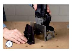
Um die Auflage auf dem Werkstück zu vergrößern, wird an die Grundplatte eine Abstützung geschraubt. Dadurch kann die Fräse besser gehalten werden und kippt nicht so leicht zur Seite.
