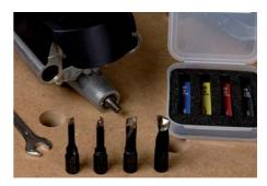
5, 6, 8 und 10 mm Spiralnutfräser können passend zu den Domino Dübelstärken schnell und einfach auf das Gewinde der Domino Dübelfräse geschraubt werden.
