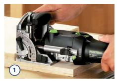
Die Domino Dübelfräse lässt sich über die Außenkanten der Maschine positionieren. Dabei wird die Grundplatte einfach bündig zur Werkstückkante ausgerichtet
