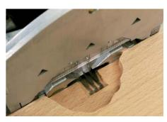
Dabei rotiert der Fräser und bewegt sich gleichzeitig nach links und rechts. So entsteht ein ovales Langloch, in das später der entsprechende Domino genau nasst
