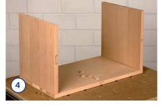
Die Dominodübel können dann schon mal probeweise in die Schlitze gesteckt werden, um die Passgenauigkeit der Verbindungen zu überprüfen.
