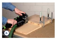
Erst danach legen Sie die Fräse flach auf die Seitenwand und fräsen die Schlitze in den Boden. Beachten Sie unbedingt diese Reihenfolge, denn beim zweiten Fräsgang könnte der Boden möglicherweise ein wenig verrutschen.
