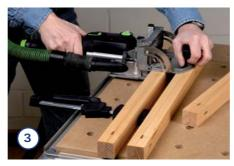
Stellen Sie die Anschlaghöhe genau auf 17,5 mm (halbe Pfostendicke) ein. Legen Sie einen zweiten Pfosten als zusätzliche Abstützung lose unter den ...
