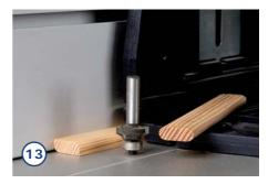
Leisten für ein 8er Langloch werden mit einem Abrundfräser mit 4 mm Radius bearbeitet. Dabei werden alle vier Kanten nacheinander abgerundet. Zum Schluss werden alle Kanten noch einmal sorgfältig geschliffen.
