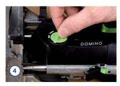
Die Schlitzbreite lässt sich über den Drehschalter so einstellen, dass der Domino genau und ohne Spiel in den Schlitz passt oder um 6 bzw. 10 mm seitlich verschoben werden kann.
