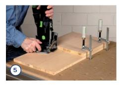
Bei einer T-Verbindung spannen Sie den Boden fest auf die Seitenwand und benutzen seine Kante als Anschlag für die Domino Dübelfräse. Fräsen Sie dann zunächst mit der hochkant stehenden Fräse die Schlitze in die Seitenwand.
