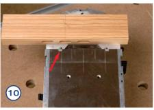
Indem Sie den linken Anschlagstift einmal links im mittleren Loch anlegen, können Sie 10 mm rechts daneben ein weiteres Langloch fräsen ...
