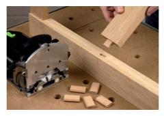
Anschließend wird das Gegenstück gefräst. Nachdem der passende Domino in den Schlitz gesteckt wurde, passen beide Holzteile perfekt zusammen.
