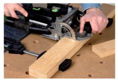
So einfach geht's: Maschinenanschlag auf das Werkstück legen und ausrichten. Dann die Fräse einschalten und das Motorgehäuse samt Fräser langsam und gleichmäßig nach vorne schieben.
