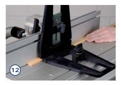
Die im Querschnitt noch rechteckigen Leisten, müssen auf dem Frästisch noch abgerundet werden. Benutzen Sie bei diesen dünnen Leisten unbedingt die beiden Andruckeinrichtungen am Frästisch.
