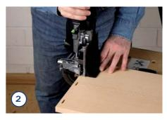
Sie müssen nur den mittleren Schlitz markieren und anschließend an der Mittenmarkierung der Abstützung ausrichten. Die beiden äußeren Schlitze werden mithilfe der Anschlagstifte gefräst.
