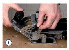
Der Anschlag ist von 0 - 90° stufenlos schwenkbar, wobei er bei den wichtigsten Graden 22,5°, 45° und 67,5° präzise einrastet
