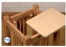
Wieder ein Beweis, wie vielseitig Domino Dübel einsetzbar sind. Der 12 mm starke Multiplexboden liegt einfach lose auf vier 8 x 40er Domino Dübeln. Dadurch kann er zum Reinigen leicht entnommen oder bei einer größeren Verschmutzung auch schnell erneuert werden. Zum Schluss kann der Blumenständer noch lackiert oder geölt und gewachst werden. Aber auch ein farbiger Lasuranstrich (z. B. in weiß) kann sehr reizvoll sein.
