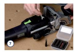
Heben Sie mit dem Maulschlüssel den Entriegelungshebel bis zum hörbaren Einrasten an. Jetzt können Sie die Motoreinheit und den Anschlag voneinander trennen.
