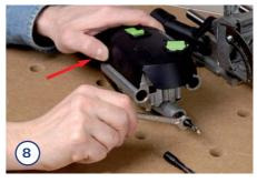
Drücken Sie die Spindelarretierung (Pfeil) und lösen Sie mit dem Maulschlüssel den Fräser. Haben Sie den Fräser gewechselt, werden Motor und Anschlag wieder zusammengesteckt.
