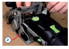
Zusätzlich kann der Anschlag auch in der Höhe verändert werden. Entweder stellt man den Anschlag frei über die Skala ein oder benutzt den Schieber (Pfeil).
