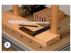
Legen Sie alle Pfosten zusammen und ziehen Sie 45 mm von oben und 135 mm von unten mit dem Winkel einen Strich, der die Mitte der Zargen markiert und später als Linie zum Ausrichten der Fräse benutzt wird.
