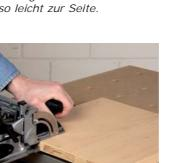
Schrankdeckel und -boden werden stirnseitig mithilfe des auf 90° geschwenkten Anschlags gefräst. Für den mittleren Schlitz die Skala im Anschlag nutzen.
