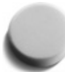
Polierschwamm Zum Polieren von lackierten Oberflächen. Unterschiedliche Härtegrade: weich für Neulacke, mittel für leichte Verwitterung und Wachsaufrag, hart für stark verwitterte Lacke. Klettenschnellbefestigung, Höhe 40 mm.
