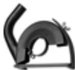
Saugerschutzhaube mit Führungsschlitten für Trennscheiben Ø 180 mm, Schnitttiefe 40 mm, Anschluss Ø 32 mm
