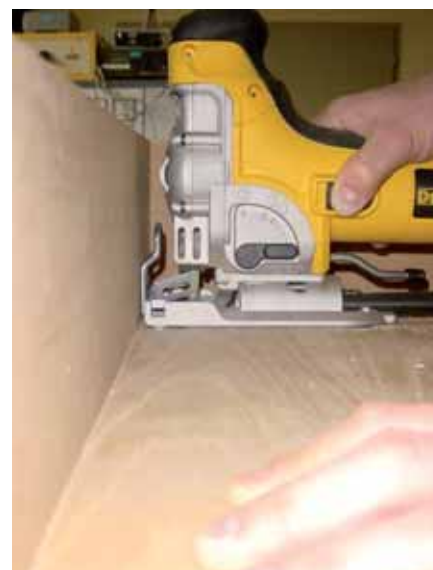
Randnahes Schneiden bis zum Anschlag des Sägeschuhs mit dem HCS-Sägeblatt DT2074.
