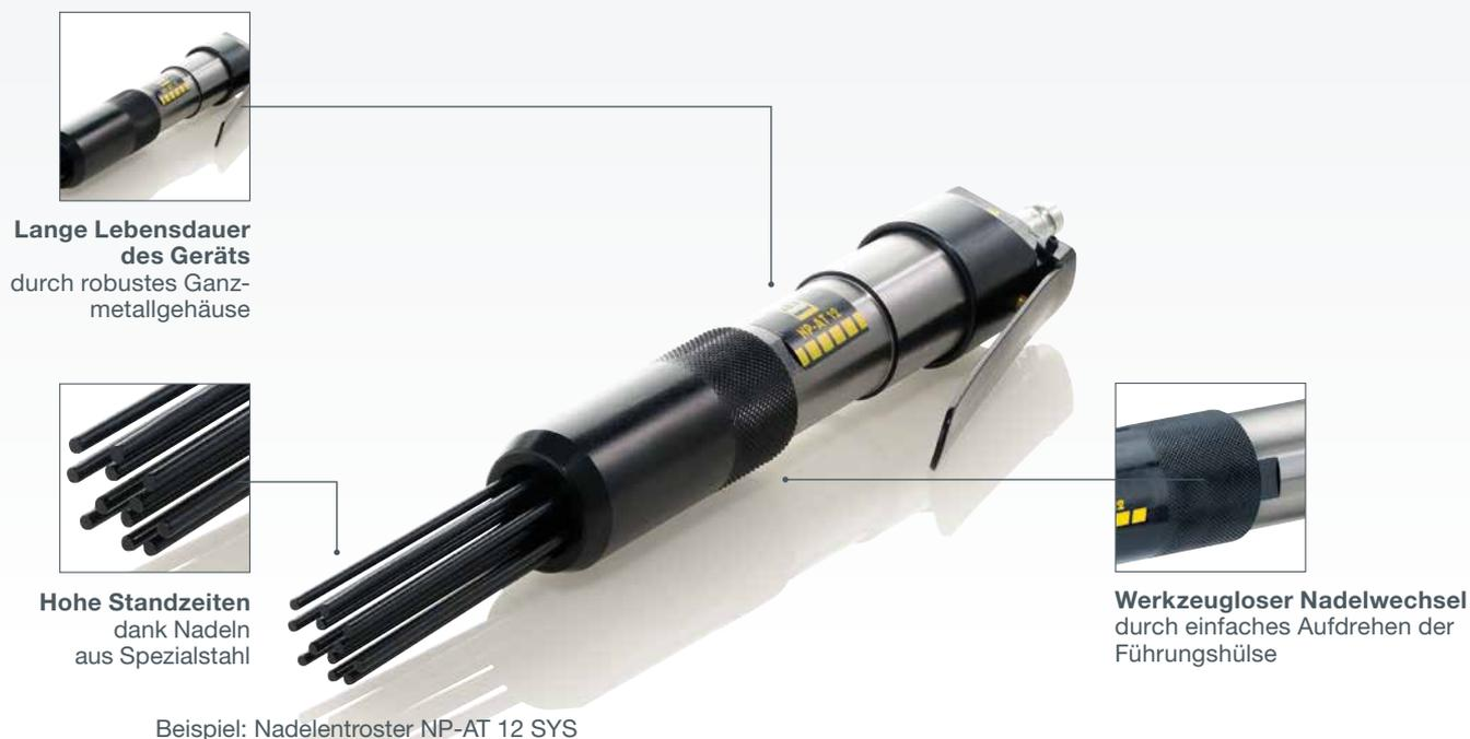
Diese Nadelentroster überzeugen durch eine besonders lange Lebensdauer dank des robusten Metallgehäuses und der hohen Standzeiten der Nadeln durch Verwendung von Spezialstahl. Sie eignen sich bestens zum Entfernen von grobem Rost, Schweißschlacke und Farbe, zur Steinbearbeitung, zum Verputzen von Schweißnähten, Aufrauen von Untergründen und zum Entfernen von Putz- und Betonresten an Betonstahl.
