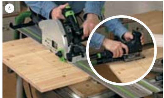
Zwei parallele Sägeschnitte im Abstand der Höhe des Lüftungsgitters vornehmen. Den Rest des Sägeschnittes und die Schmalseiten mit der Stichsäge aussägen.
