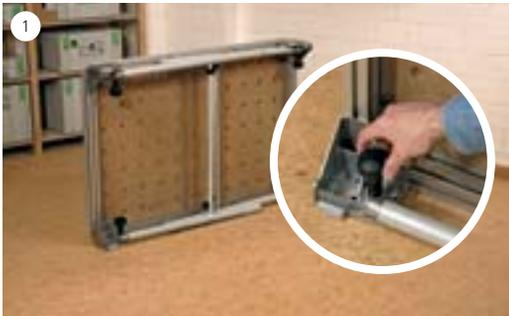
Legen Sie den MFT 3 auf die Seite und lösen Sie die Drehknöpfe für die ausklappbaren Beine.
