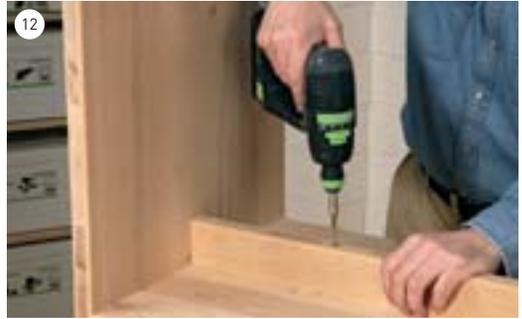
12 Nachdem der Leim abgebinden hat, wird die Querzarge mit Schrauben an der Platte befestigt.
