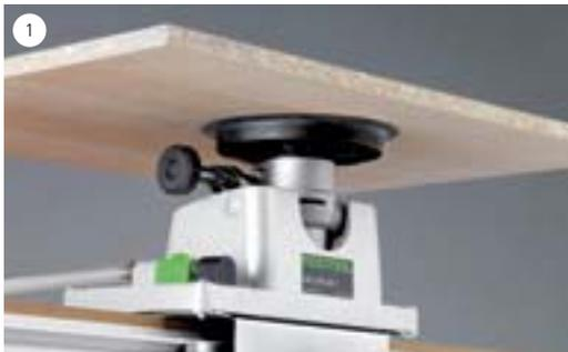
Für unterschiedlich große Werkstücke stehen vier verschiedene Vakuumenteller zur Verfügung.
