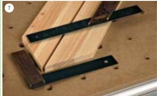
TIPP: Eine 45°-Gehrung kann man auf zwei Arten überprüfen: entweder mit einem 45°-Gehrungswinkel oder mit einem 90°-Präzisionswinkel.
