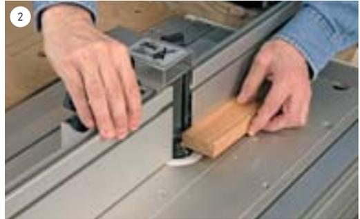
Mit einer Holzleiste kann man sehr gut die Position des Anschlags zum Fräserprofil vorjustieren.
