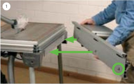
**Umbau des Schiebetisches:** Die Führungsschiene des Schiebetisches muss so an der MFT 3-Verlängerung befestigt werden, dass sie hinter dem Sägeblatt übersteht.
