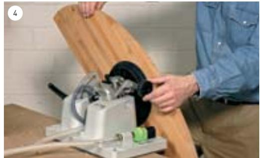
Der Teller kann aber auch mitsamt dem Werkstück in jede beliebige Position gedreht werden.
