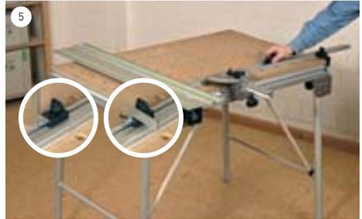
Nun schieben Sie den klappbaren Anschlagreiter in die Nut des Anschlaglineals. Dort lässt er sich an jeder beliebigen Stelle mit der Schraube befestigen.
