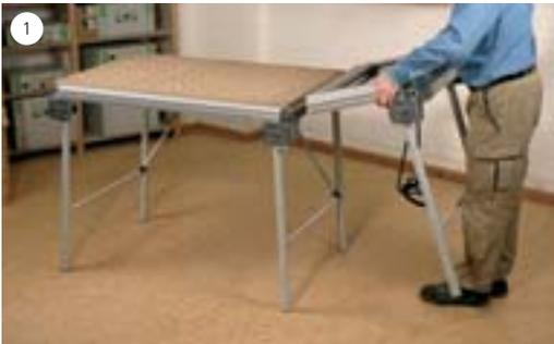
1 Die Standbeine der MFT 3-Verlängerung werden wie beim MFT 3 ausgeklappt und mit einer Befestigungsschraube arretiert.
