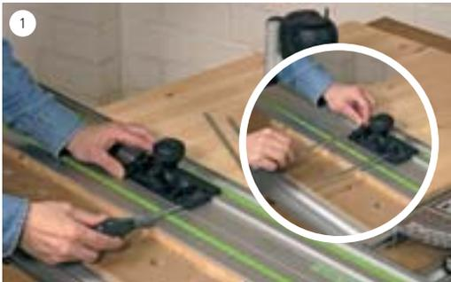
Den Führungsanschlag auf die Schienenrippe der Führungsschiene schieben und mit einem Schraubendreher die beiden Führungsbacken im Anschlag einstellen. Führungsstangen in den Anschlag stecken und mit den Schrauben befestigen.
