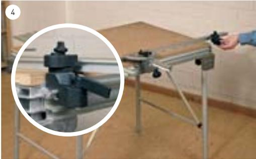
Die Zusatzklemmung fixiert das äußere Ende des Anschlaglineals. Sie wird in das Profil des Tisches eingeschoben und dort mit dem Klemmhebel befestigt.
