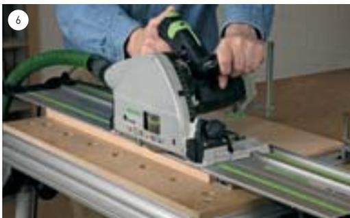
6 Achten Sie dabei darauf, dass beide Führungsbacken während des gesamten Sägevorgangs in die Führungsrippe der Schiene eingreifen.
