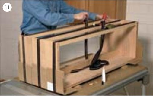
11 Zum Schluss das andere Seitenteil mit Leim einstecken und alles mit Spanngurten verleimen.
