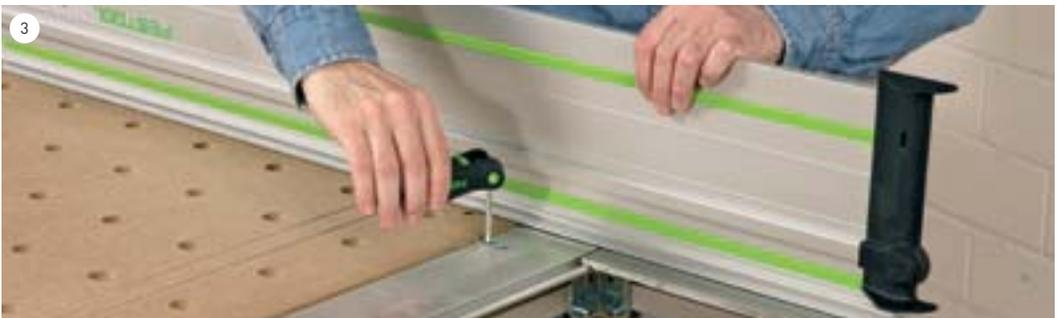
3 Stellen Sie danach mit der zum MFT 3 zeigenden Schraube die Höhe der Tischverlängerung genau auf das Niveau des MFT 3 ein.
