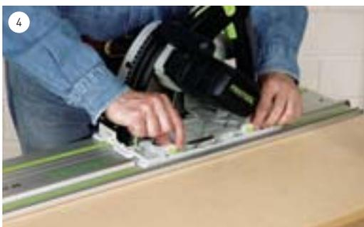
4 Nun legen Sie die Tauchsäge auf die Führungsschiene und stellen die beiden Führungsbacken im Sägertisch „spielfrei“ auf die Führungsrippe der Schiene ein.
