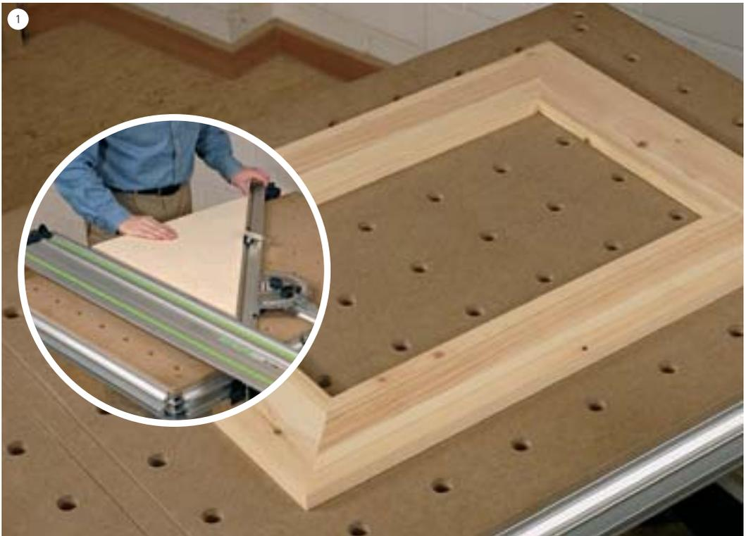
Stellen Sie zwischen Anschlaglineal und Führungsschiene einen Winkel von exakt  $45^\circ$  ein.
