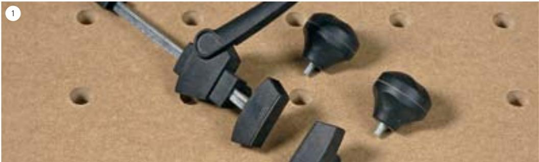
Die Spannelemente werden in die Tischlöcher gesteckt und von unten mit einem Drehknopf fixiert. Sie bestehen aus einem Anschlag und dem beweglichen Spannelement mit Hebelgriff.
