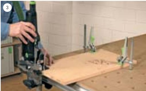
Beim Sägen, Bohren oder Fräsen kann das Brett zur Bearbeitung über den MFT 3 hinaus ragen und dabei mit den Zwingen sicher gehalten werden.
