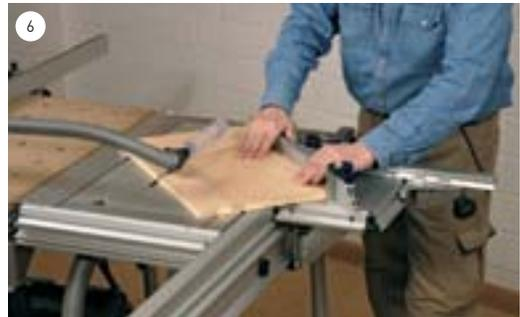
**Brett mit Doppelgehrung:** Ein präziser Zuschnitt einer Doppelgehrung ist immer eine Herausforderung – nicht nur für die Maschine! Dabei müssen sowohl das Sägeblatt als auch der Anschlag geschwenkt werden.
