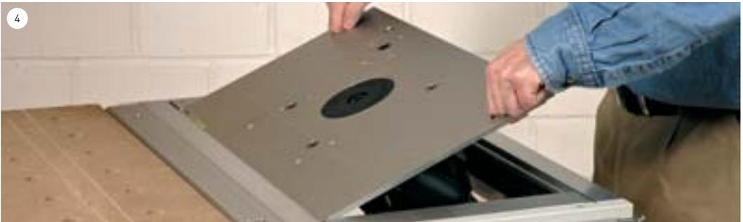
Zum Schluss wird die Platte gedreht, in die Tischöffnung eingelegt und mit zwei Schrauben am Tischprofil verriegelt.
