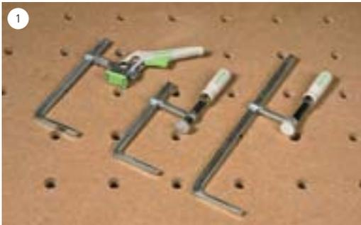
Die Zwingen werden in zwei unterschiedlichen Ausführungen angeboten: als Hebelzwinge oder als klassische Schraubzwinge in verschiedenen Längen.
