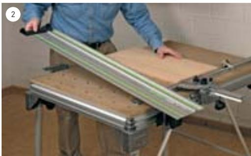
2 Hierfür legen Sie ein etwa 60 cm breites Brett unter die Führungsschiene und schieben es bis auf ca. 5 mm an die Außenkante des Splitterschutzes heran.
