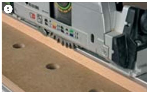
5 Stellen Sie die Drehzahl auf Stufe 3 und die Schnitttiefe auf ca. 7-10 mm ein und sägen einmal die gesamte Führungsschiene entlang.
