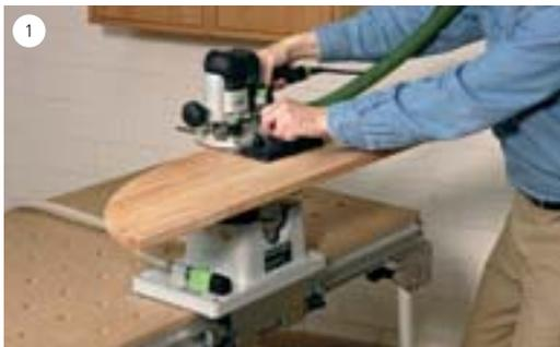
Mittels Vakuum werden die Werkstücke sicher gespannt. Hierzu genügt es, die Werkstücke mit leichtem Druck auf den Vakuumenteller zu legen.
