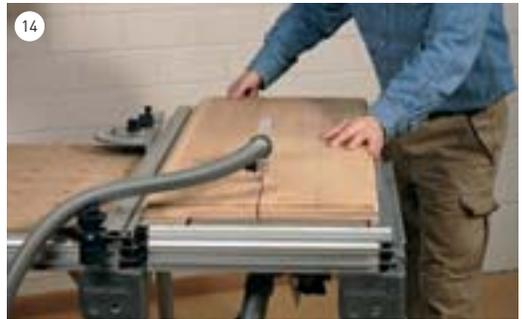
14 Anschließend sägen Sie aus der breiten Platte die beiden 217 mm breiten Streifen für die Sitzplatten.
