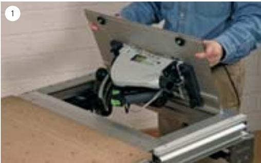
In wenigen Sekunden einsatzbereit: Das Tischsägemodul wird einfach in das Trägermodul der MFT 3-Verlängerung eingelegt und fixiert.
