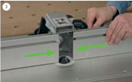
Die Anschlagsschienen (Anschlagbacken) werden anschließend so nah wie möglich an den Fräser herangeführt.
