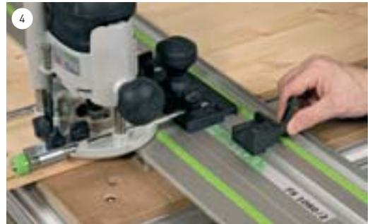
Auch diese Position zeigt immer die Mitte des Fräsers an. Zum Schluss eine Führungsbegrenzung auf die Schiene stecken und bis zum Führungsanschlag heran schieben und fixieren.
