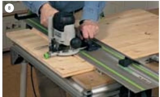
8 Dabei wird die rechte Nutflanke im Gegenlauf und die linke im Gleichlauf gefräst. Das ist aber aufgrund der Zwangsführung auf der Schiene kein Problem.
