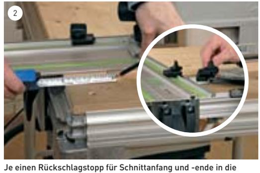
Je einen Rückschlagstopp für Schnittanfang und -ende in die obere Nut der Führungsschiene einschieben. Anfang und Ende des Sägeschnittes markieren, um die Sägeblattzähne daran auszurichten.
