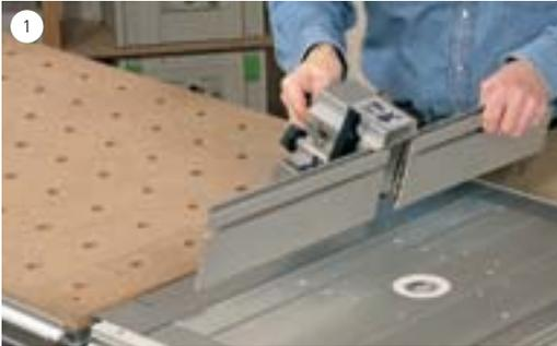
Je nach gewünschtem Abstand zum Fräser kann der Fräsanschlag an zwei unterschiedlichen Positionen auf der Tischfläche befestigt werden.
