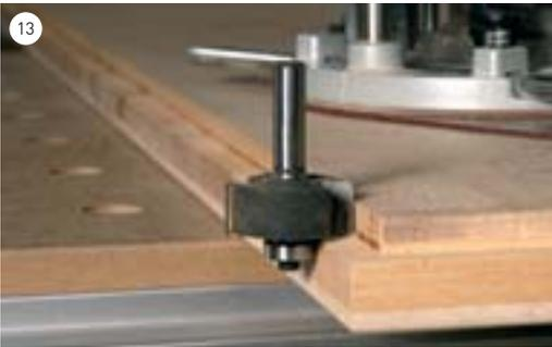
13 Mit einem Falzfräser mit Kugellager fräsen Sie an die Sitzplatte einen 8 mm breiten und 8 mm tiefen Falz.
