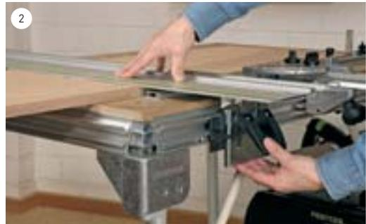
2 Anschließend stellen Sie Schwenk- und Auflageeinheit der Führungsschiene genau auf die Dicke Ihres Werkstückes ein.
