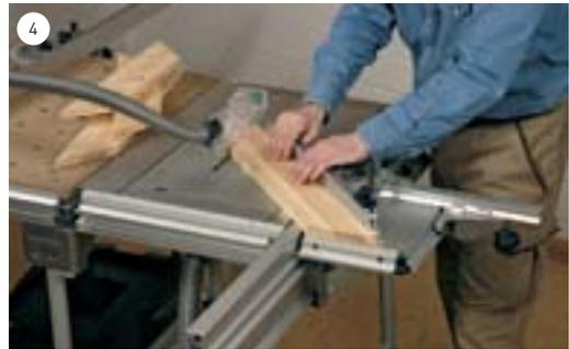
**Rahmen auf Gehrung:** Rahmenhölzer zum Bau von Möbeltüren oder Bilderrahmen können hervorragend mit dem auf 45° eingestellten Winkelanschlag passgenau auf Gehrung zugeschnitten werden.
