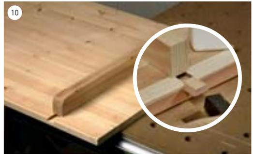
10 Das offene Ende der Nut kann aus optischen Gründen auch mit einem schwalbenschwanzförmigen Klötzchen verschlossen werden. Achten Sie darauf, dass genügend Luft bleibt, damit das Holz arbeiten kann.
