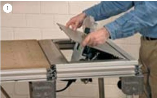
Die Modulplatten werden an einer Seite in die Tischverlängerung einglegt und anschließend nach unten abgesenkt.
