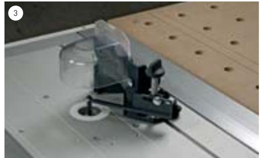
3 Am Bogenfräsanschlag: bei geschweiften Werkstücken.
