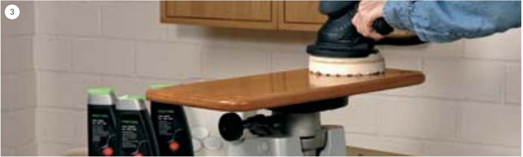
Selbst auf hochglanzpolierten Flächen hinterlassen die Vakuummesser weder Kratzer noch Beschädigungen.
