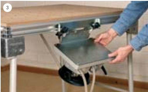
Bei Nichtgebrauch wird die Spanneinheit einfach platzsparend unter den Tisch geschwenkt und mit 2 Drehknöpfen dort arretiert.
