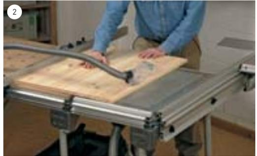
**2** Platte auf Breite am Längsanschlag: Die so vorbereitete Plattenkante kann jetzt an den Längsanschlag gelegt werden, um die Platte genau auf Breite zu sägen.
