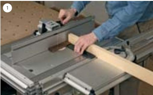
Zunächst einmal muss der Schiebetisch absolut parallel zum Fräsanschlag laufen, gleichzeitig muss die Anschlagleiste genau rechtwinklig eingestellt werden.
