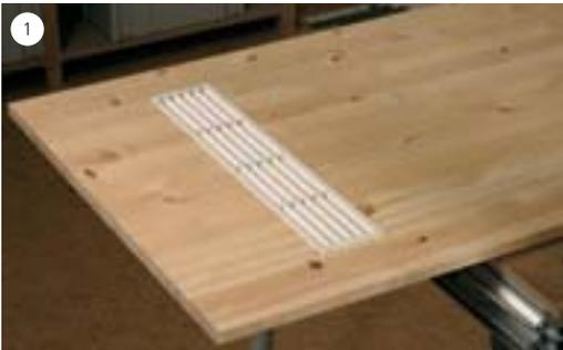
Die Aussparungen für Lüftungsgitter können mit dem MFT 3 und einer Tauchsäge millimetergenau gesägt werden.
