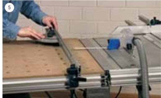
Parallelität des Anschlaglineals zum Sägeblatt nachmessen: Mit einem Bandmaß erst den Abstand des Anschlags zum vorderen, dann zum hinteren Zahn des Sägeblatts messen.
