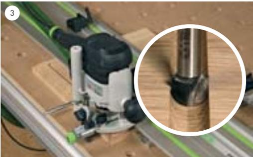
Die Fräse am hinteren Führungsbegrenzer aufsetzen, Frästiefe einstellen, Maschine einschalten und den Fräser ins Holz eintauchen. Die Fräse sofort nach vorne schieben bis sie am vorderen Begrenzer anstößt.
