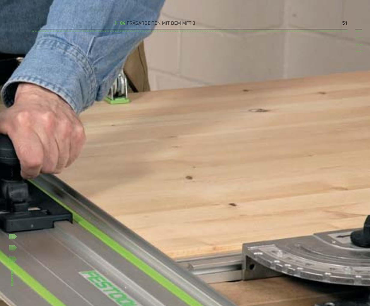
Kaum ein anderes Elektrowerkzeug bietet so viele Anwendungsmöglichkeiten wie die Oberfräse. Mit ihr kann man sehr einfach Falze, Nuten und unzählige Profilvarianten herstellen. Aber auch hier gilt: Ein exaktes Fräsergebn wird nur durch die perfekte Führung der Oberfräse während des Fräsens möglich. Mit Hilfe der Führungsschiene
