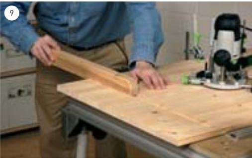
9 Zum Schluss die passend gefräste Gratfeder lose ohne Leim in die Nut einschieben.
