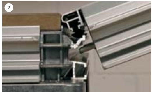
2 Anschließend wird die Tischverlängerung in das umlaufende Aluprofil des MFT 3 eingehängt.
