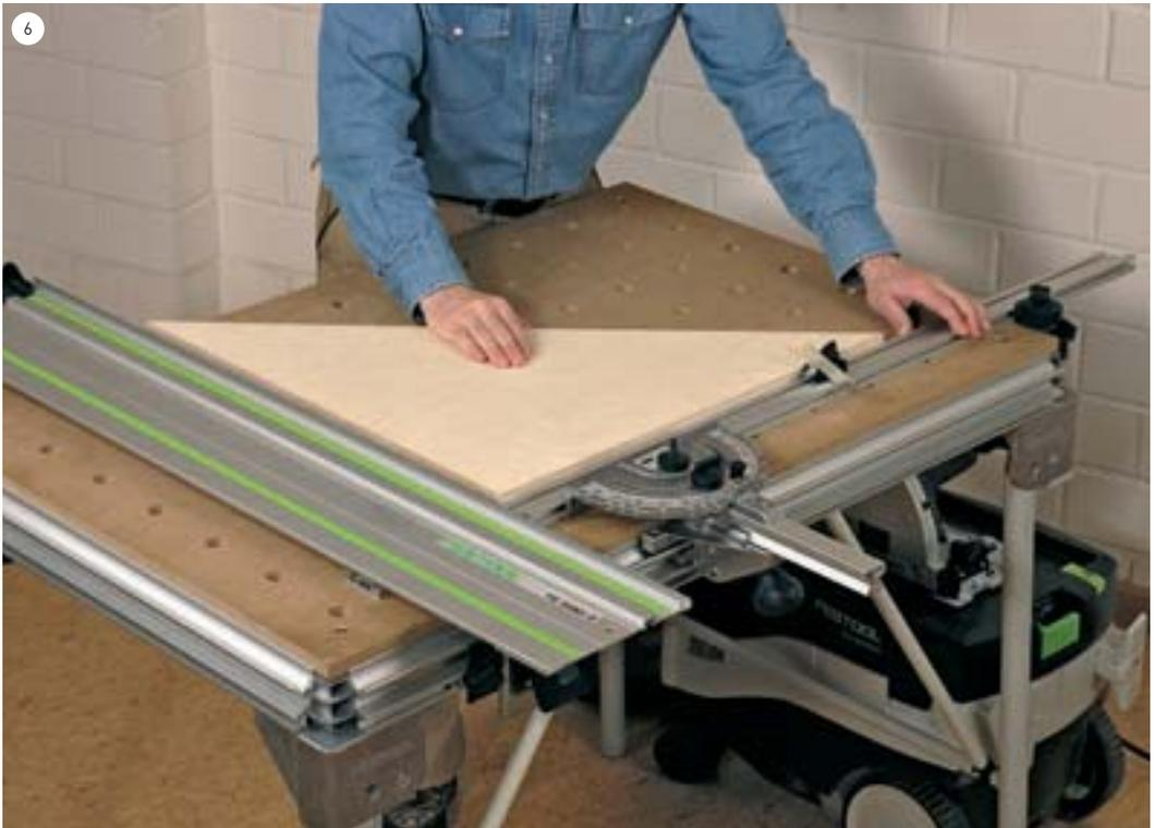
Mit Hilfe eines großen Präzisionswinkels oder eines genau rechtwinklig zugeschnittenen Brettes sollte vor jedem rechtwinkligen Zuschritt der Winkel zwischen dem Anschlaglineal und der Führungsschiene eingestellt werden.
