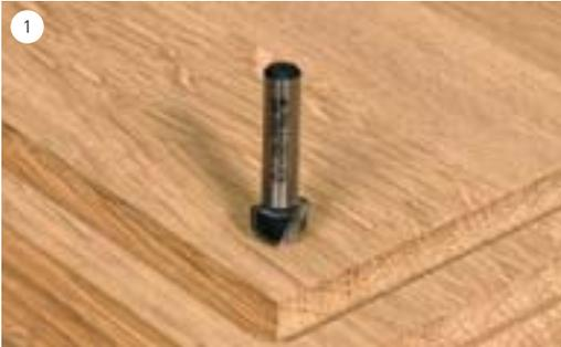
Für das Innenprofil können nur stirn-schneidende Fräser eingesetzt werden, die ins Holz eintauchen können.
