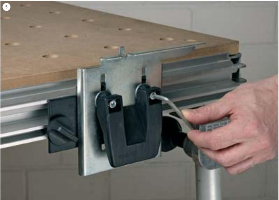
Die Stärke der Hebelspannung kann über die beiden Innensechskantschrauben genau dosiert werden.
