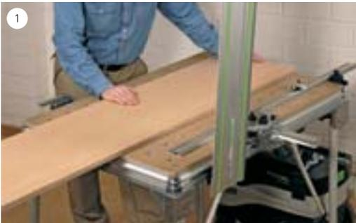
1 Klappen Sie die Führungsschiene hoch und legen Sie Ihr Werkstück am Anschlaglineal an.
