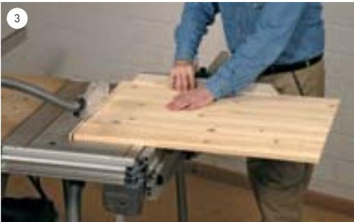
**3** Nachdem die Platte parallel auf ein bestimmtes Breitenmaß zugeschnitten ist, muss sie auf die gewünschte Länge gekürzt werden. Dazu wird zuerst eine Querkante genau winklig zu den beiden Längskanten zugeschnitten.
