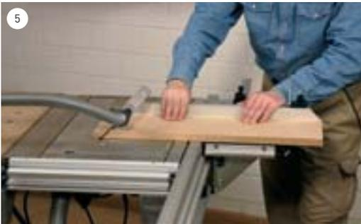
**Brett auf Gehrung:** Sollen Brettenden auf Gehrung gesägt werden, wird nicht der Anschlag sondern diesmal das Sägeblatt um 45° geschwenkt.
