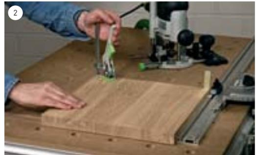
Den Anschlag und den Anschlagreiter einstellen, das Brett dagegen legen und mit einer Zwinne befestigen. TIPP: Für eine gleichmäßige Profilierung aller Kanten muss das Brett immer fest am Anschlagreiter anliegen.
