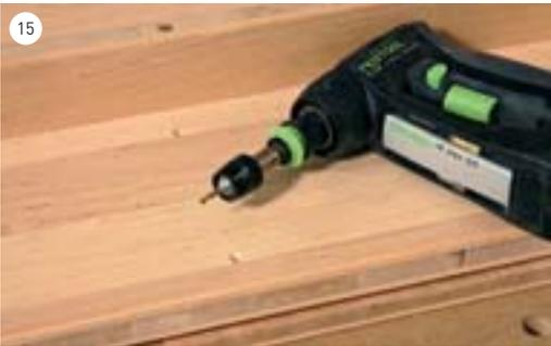
15 Mit einem Bohrensenker mit Tiefenanschlag bohren Sie Löcher für die Schrauben.
