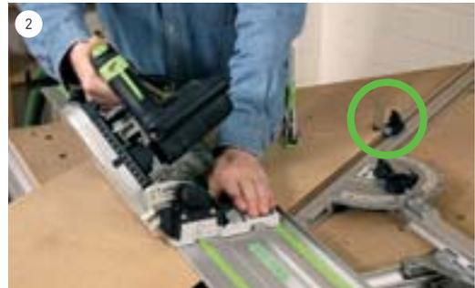
Achten Sie deshalb darauf, dass die Werkstücke immer genau gegen den Anschlag und den Anschlagreiter (grüner Kreis) anliegen.
