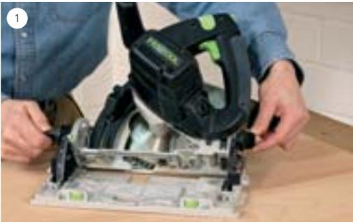
Die Klemmschrauben lösen und Sägeblatt stufenlos in jeden beliebigen Winkel von 0°–45° schwenken. Bei 45° ist ein nachjustierbarer Endanschlag.
