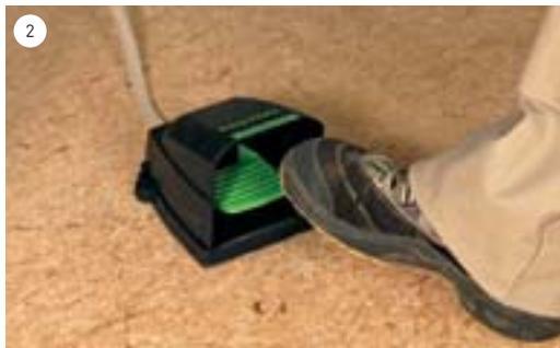
Mit dem Fußventil belüften Sie den Vakuumenteller und können gleichzeitig das Werkstück mit beiden Händen festhalten.
