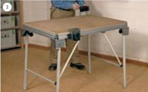
Die Auflageeinheit wird entsprechend am gegenüberliegenden Längsprofil eingeschoben und befestigt.
