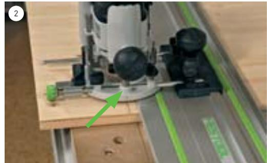
Die Oberfräse auf die Führungsschiene setzen und so verschieben, dass die Kerbe im Frästisch der Maschine (Pfeil) mit dem Bleistiftstrich übereinstimmt. Diese Kerbe zeigt immer die Mitte des Fräsers an.
