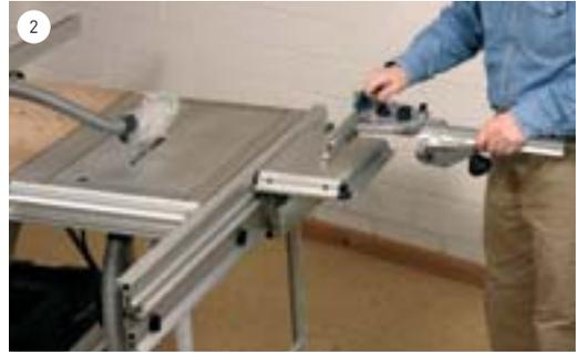
**Versetzen des Winkelanschlages:** Der Winkelanschlag wird an das seitliche Profil des Schiebetisches eingehängt und fixiert.
