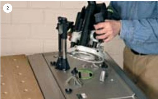
Legen Sie das Einsatzmodul mit der Oberseite auf den Tisch. Einlegering in die Öffnung legen und Fräse aufsetzen. Bitte beachten Sie die Bedienungsanleitung.
