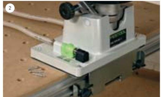
Zusätzlich wird die Spanneinheit mit vier Maschinenschrauben mit der Adapterplatte verbunden. Die Adapterplatte wird mit einer Schraubzwinde an der Lochplatte des MFT 3 fixiert.
