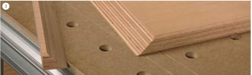
Achten Sie beim Sägen auf einen gleichmäßigen Vorschub der Maschine und sorgen Sie dafür, dass die Säge immer mit der Führungsnut auf der Schiene bleibt. TIPP: Bei Tauchschnitten Rückschlagstopp verwenden!
