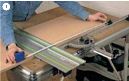
1 Den Anschlagreiter mit einem Bandmaß auf die gewünschte Werkstücklänge einstellen. Das korrekte Maß können Sie dann am Splitterschutz ablesen.
