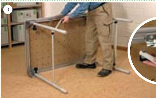
**TIPP:** Für noch mehr Stabilität sorgen die Querstreben (Zubehör). Achten Sie beim Aufstellen des Tisches darauf, dass die Querstreben nach hinten zeigen.
