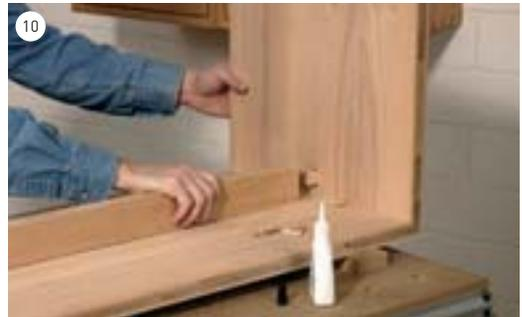
Stecken Sie zuerst die Platte mit einem Seitenteil und Leim zusammen. Danach stecken Sie die Querzarge ein.
