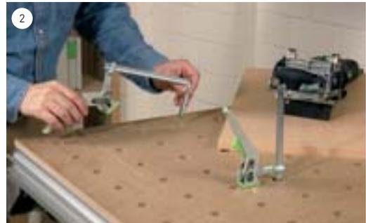
Die Hebelzwinge ganz nach oben ziehen und komplett öffnen. Jetzt kann der untere Teil der Zwinge in eines der Löcher in der Tischplatte gesteckt werden.
