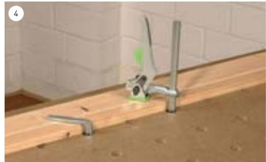
Die Schraub- und Hebelzwingen können sowohl von oben, als auch von unten in die Tischlöcher gesteckt werden.
