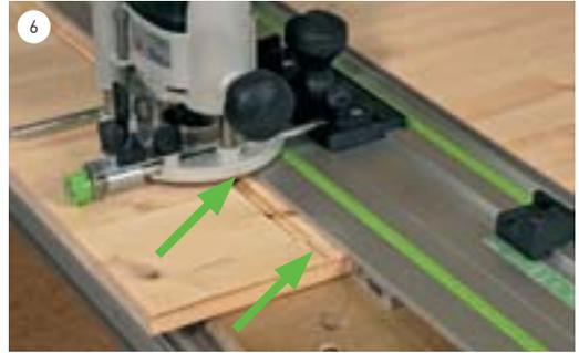
6 Die Kerbe im Frästisch bzw. die Bleistiftmarkierung zeigen genau die Nutmitte an.
