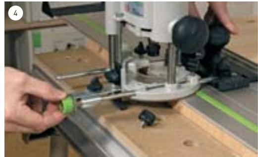
Ein nützliches Zubehör ist die Feineinstellung für den Führungsanschlag. Sie wird einfach seitlich auf die Stange geschoben und mit zwei Schrauben fixiert.
