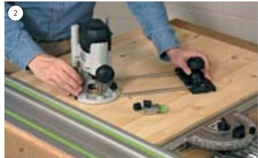
Den Führungsanschlag samt Stangen seitlich in die Aufnahme-löcher der Oberfräse stecken.
