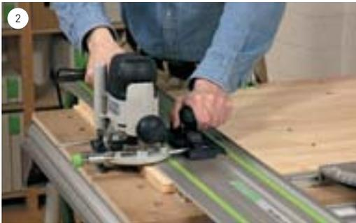
Die Maschine gleichmäßig und zügig an der Kante entlang führen.
