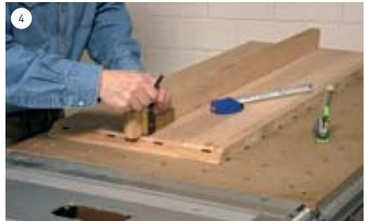
Legen Sie die etwas längere Querzarge auf die Plattenunterseite
