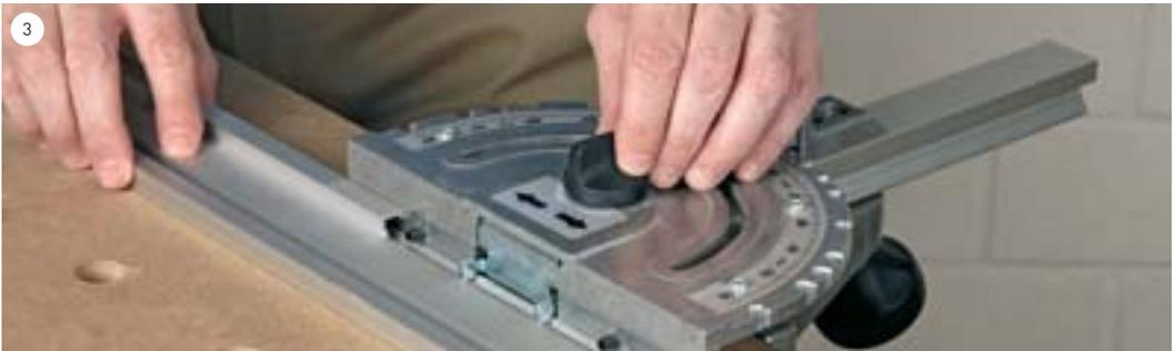
Schieben Sie nun das Anschlaglineal auf den Winkelanschlag. Mit der Schraube ziehen Sie anschließend das Profil fest an den Winkelanschlag. TIPP: Das Anschlaglineal kann auch senkrecht eingesetzt werden.
