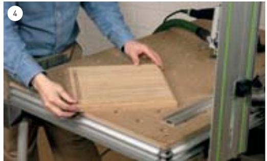
Nach und nach werden alle vier Kanten an den Anschlag und den Anschlagreiter gelegt und die Nut gefräst. Lassen Sie den Fräser nie im Holz zum Stillstand kommen!
