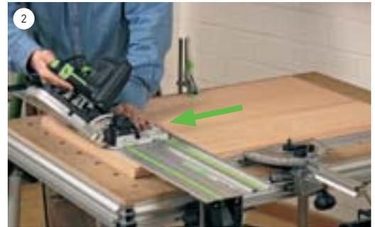
Setzen Sie die Tauchsäge vor dem Werkstück auf die Führungsschiene. Drücken Sie die Maschine fest auf die Führungsschiene, während Sie die Säge entriegeln, einschalten und eingetaucht in das Werkstück einfahren.
