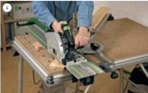
Setzen Sie die Säge zwischen Stützholz und Rahmenholz auf die Schiene und sägen Sie die Gehrung an.
