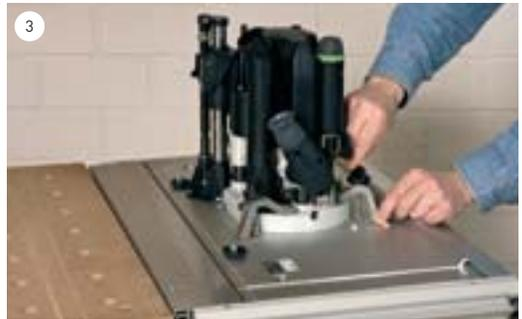
Dadurch wird die Oberfräse gleichzeitig zentriert und muss nur noch mit den drei Befestigungsklammern gesichert werden.
