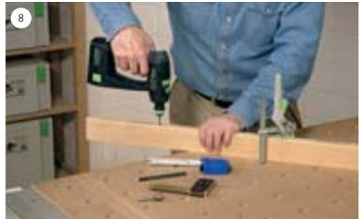
Bohren Sie in die Querzarge drei Löcher, um sie später mit Schrauben an der Platte zu befestigen.
