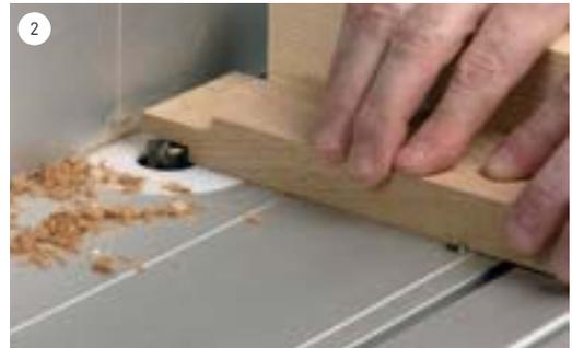
2 Am Schiebetisch: bei kurzen Werkstücken, Zapfen fräsen und Konterprofilfräsen.
