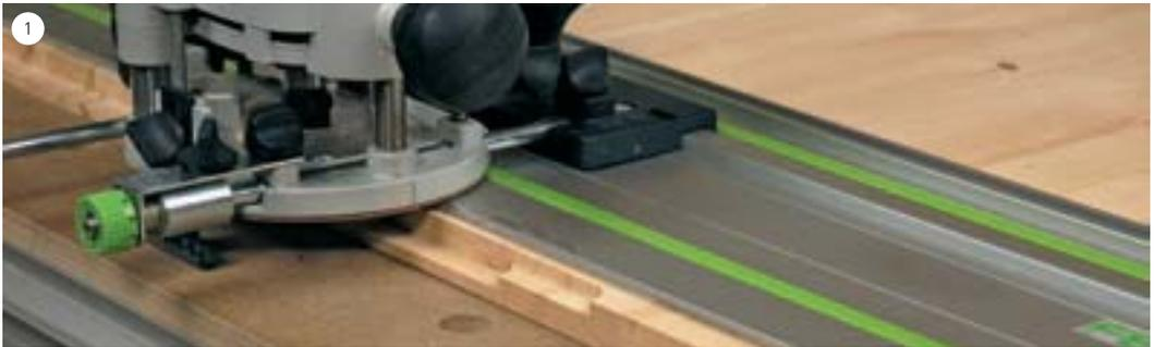
Große Falze immer in mehreren Schritten fräsen. Das ergibt nicht nur ein besseres Fräsbild, sondern schont auch den Fräser.
