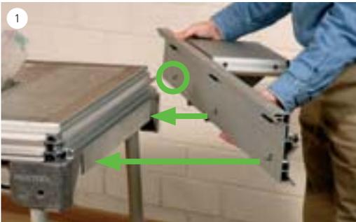
Der Schiebetisch kann in zwei Positionen angebau werden (abhängig davon, ob der Winkelanschlag vorne oder hinten am Schiebeschlitten montiert wird). Den Schiebetisch in das V-Nutprofil einhängen und festschrauben.
