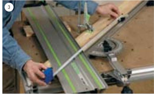
Das Rahmenholz mit einer Zwinde befestigen und Rahmenlänge mit einem Bandmaß am Anschlagreiter einstellen.
