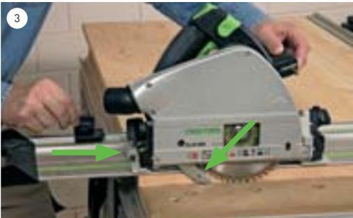
Das Sägeblatt absenken, an der Markierung ausrichten und den Rückschlagstopp bis zur Säge schieben und fixieren.
