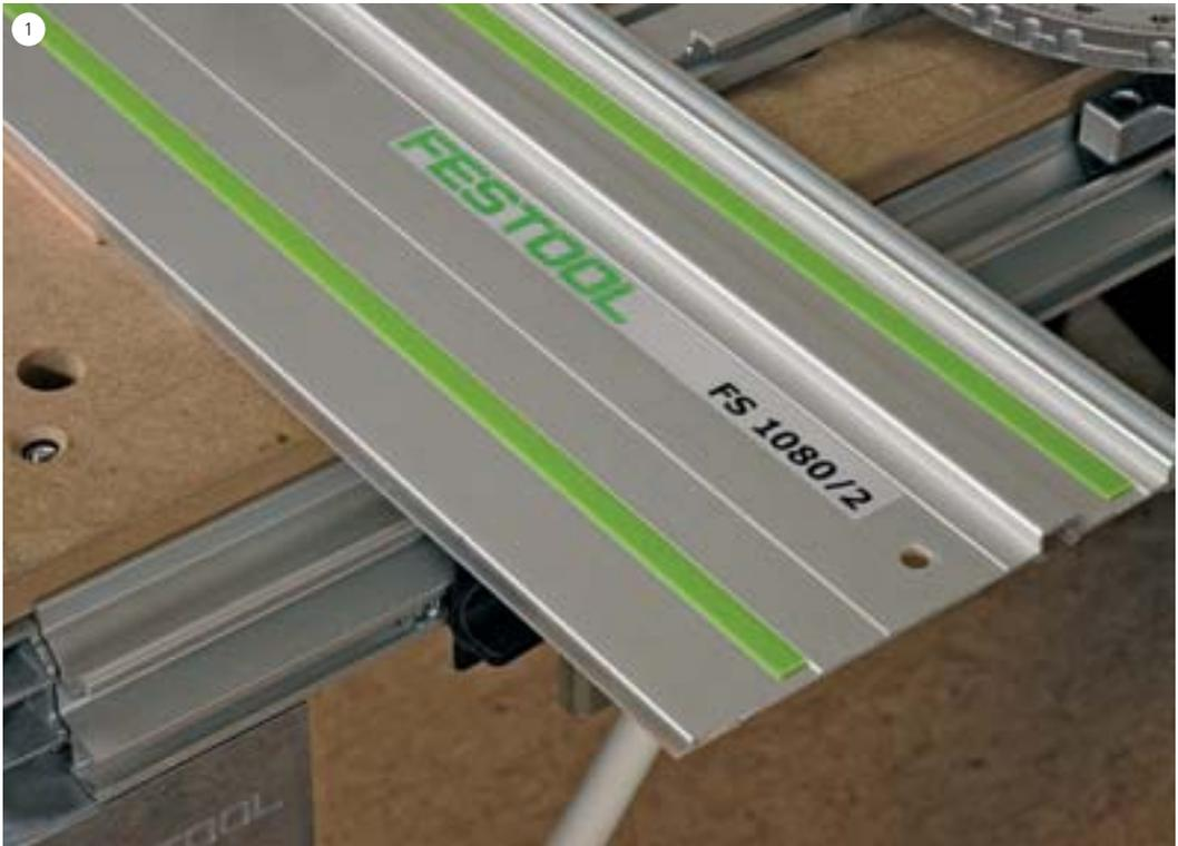
Vor der ersten Benutzung der Führungsschiene muss der Splitterschutz mit der Tauchsäge eingesägt werden.
