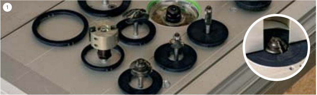
Je nach Fräsdurchmesser muss auch der passende Einlegering gewählt werden. Der Spalt zwischen Ring und Fräser sollte möglichst klein sein.
