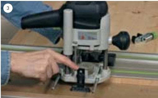
Die Fräse mit dem Anschlag auf die Schiene setzen und die Abstüzung so einstellen, dass die Maschine nicht mehr zur Seite wegkippen kann.
