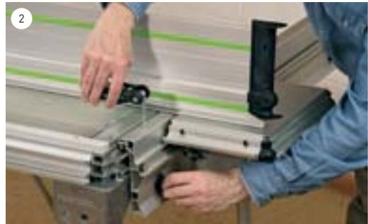
Schiebetischhöhe einstellen: Nach Lösen des Drehknopfes die Höhe gegebenenfalls nachjustieren. Der Winkel des Schiebeschlittens kann ebenfalls nachjustiert werden.
