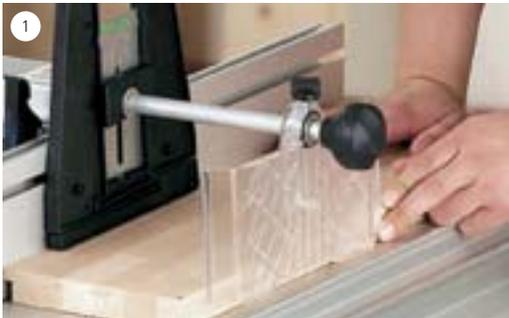
1 Am Anschlag: Profilieren, Falzen und Nuten bei geraden Werkstücken.
