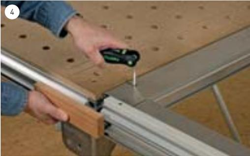
Mit der daneben liegenden Klemmschraube wird die Tischverlängerung am Aluprofil fixiert.
