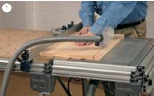
Nachdem die gewünschte Holzbreite am Längsanschlag eingestellt wurde, wird das Werkstück einfach am Anschlaglineal vorbei geführt.
