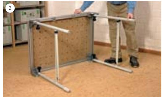
Klappen Sie die Beine komplett nach außen, bis sie einrasten. Ziehen Sie danach die Drehknöpfe wieder gut an.
