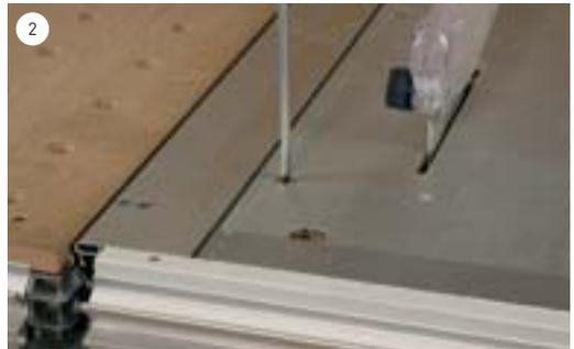
Mit zwei Schrauben wird das Modul sicher und fest mit der Tischverlängerung verriegelt.
