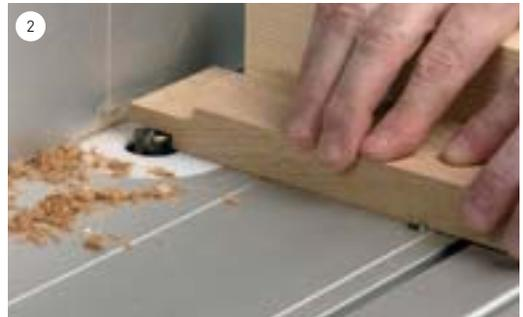
Fräsen Sie den Zapfen von beiden Seiten mit einem Nutfräser an. Fräsen Sie in mehreren Durchgängen bis die Stirnkante am Anschlag anliegt.
