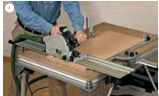
4 Die Säge vor dem Werkstück auf die Schiene setzen und in eingetauchtem Zustand in das Brett einfahren.
