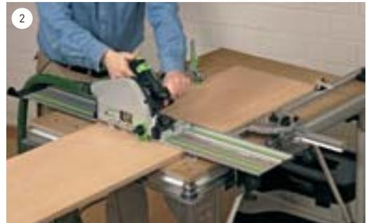
2 Den Anschlagreiter hochklappen und das Brett ca. 2 cm über den Anschlagreiter hinaus schieben. TIPP: Vorher korrekte Schnitttiefe kontrollieren (Faustregel: Brettstärke plus 5 mm).
