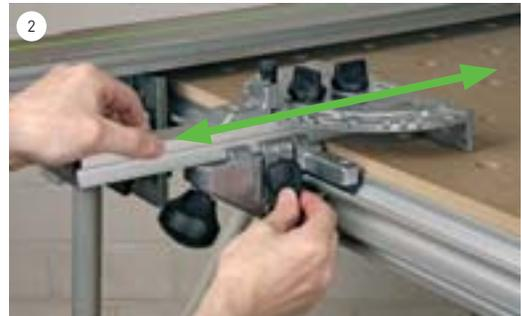
Die Position des Winkelanschlages auf der Tischplatte ist flexibel einstellbar.
