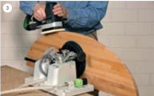
In senkrechter Position können Sie beispielsweise ganz bequem eine Plattenkante schleifen. Ein großer Vorteil ist hierbei auch die gesunde und ergonomische Haltung beim Bearbeiten des Werkstückes.
