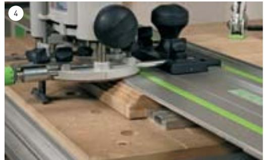
... da hier am Ende des Brettes ein mehr oder weniger starker Holzaustriss entsteht. Dieser wird nach dem Fräsen der Längskanten wieder wegfräst.
