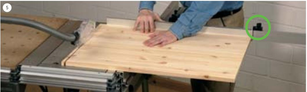
**5** Nun wird die Platte mit der in Schritt 3 gesägten winkligen Kante gegen den Anschlagreiter (grüner Kreis) gelegt und genau auf Maß abgelängt. TIPP: Die Zusatzklemmung kann auch am Schiebetisch genutzt werden.
