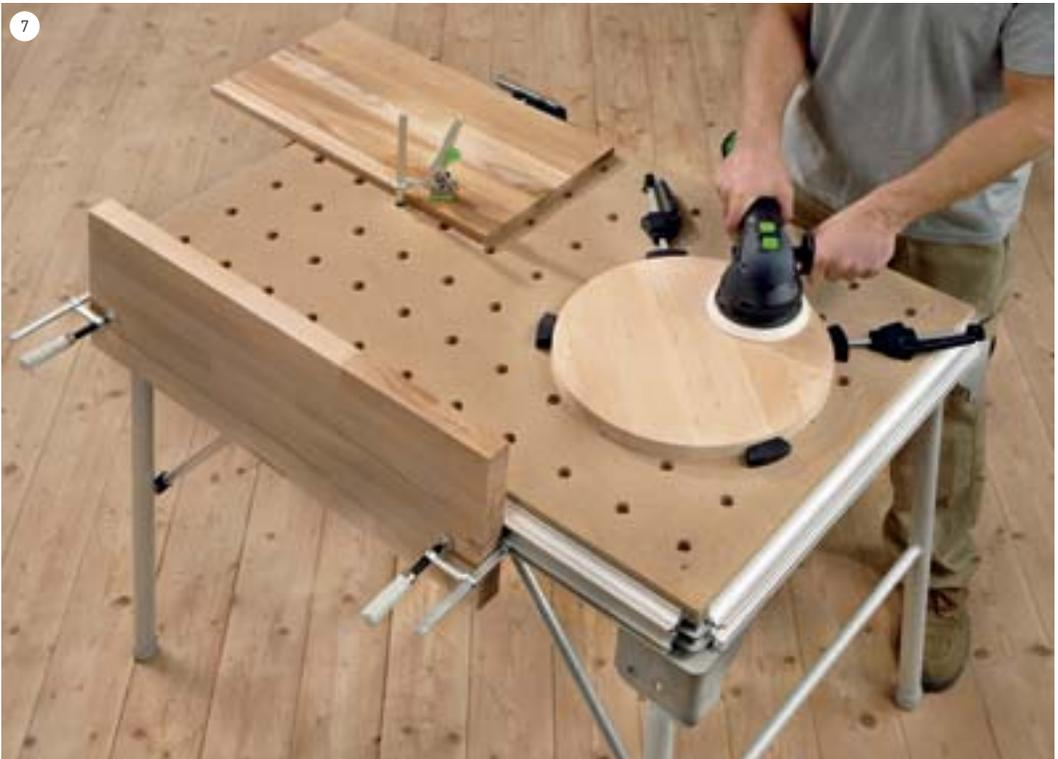
Dank des 96-mm-Lochrasters und des umlaufenden Profils des MFT 3 können Sie Werkstücke sowohl horizontal als auch vertikal spannen. Detaillierte Informationen zu den Spannelementen sehen Sie auf den Folgeseiten.
