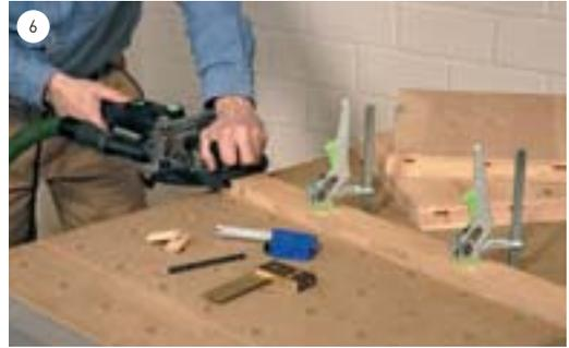
Mithilfe des Leistenanslags der Dominofräse fräsen Sie je einen 10 x 50er Domino in die Stirnkanten.
