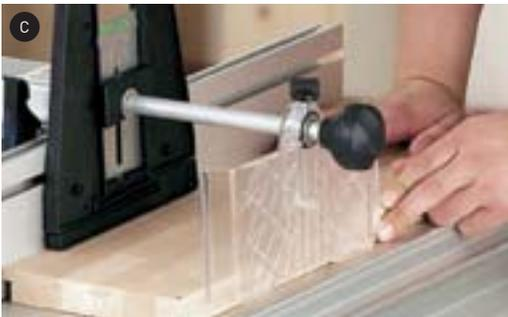
Das Fräsmodul ist vor allem bei der Bearbeitung von Leisten und schmalen Werkstücken die ideale Ergänzung zum Fräsen mit der Führungsschiene auf dem MFT 3.
