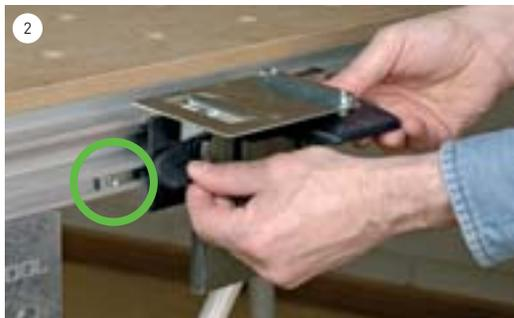
Nun können Sie die gesamte Einheit bis zum Anschlag in der Nut schieben und mit dem Drehknopf fixieren.
