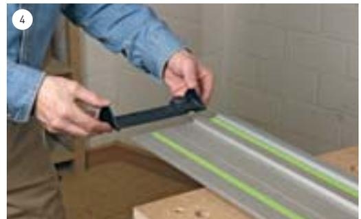
Zuletzt stecken Sie noch den Abweiser auf das Ende der Führungsschiene – so können sich Saugschlauch und Kabel nicht am Schienenende verhaken.
