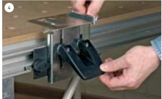
Mit Hilfe des Spannhelbs können Sie beide Einheiten in der Höhe verstellen und exakt auf Ihre Werkstückdicke anpassen.
