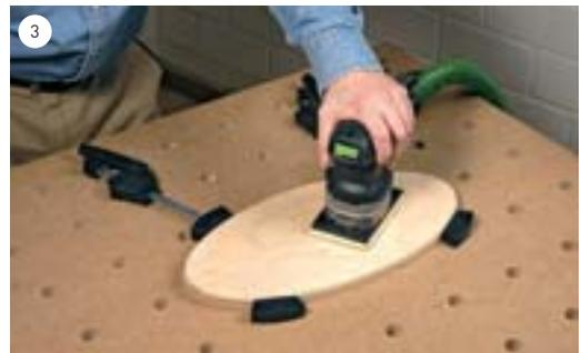
Die Werkstückoberfläche kann so ohne störende Zwingen bequem bearbeitet werden.
