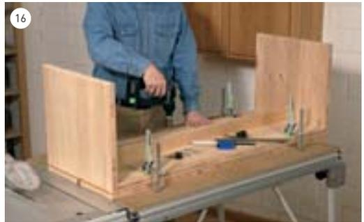
16 Fixieren Sie die Sitzplatten mit Zwingen und befestigen Sie sie mit 4 x 45er Schrauben.
