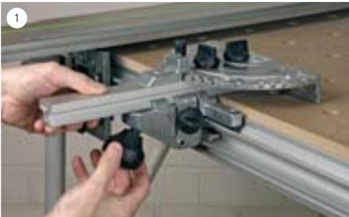
Setzen Sie den Winkelanschlag ca. 8 cm von der Führungsschiene entfernt in das Tischprofil ein und fixieren Sie ihn durch Drehen des unteren Drehknopfes.
