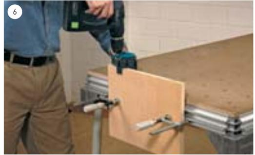
Jetzt können die Kanten des Werkstückes bequem bearbeitet werden, wie beispielsweise beim Bohren von Löchern.
