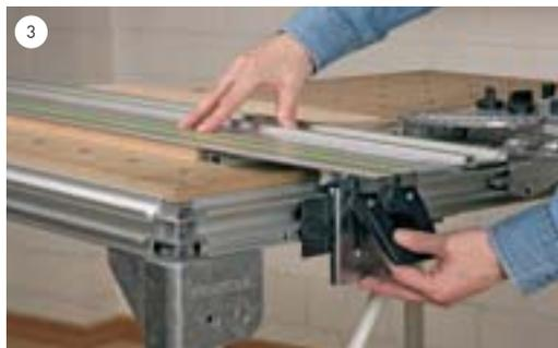
3 Stellen Sie die Schwenk- und die Auflageeinheit genau auf die Höhe des Brettes ein.
