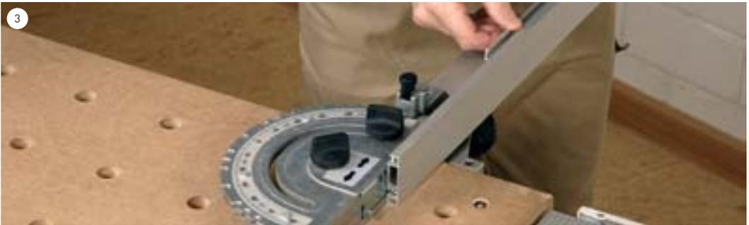
Schieben Sie das Anschlaglineal in den Anschlagkopf ein.
