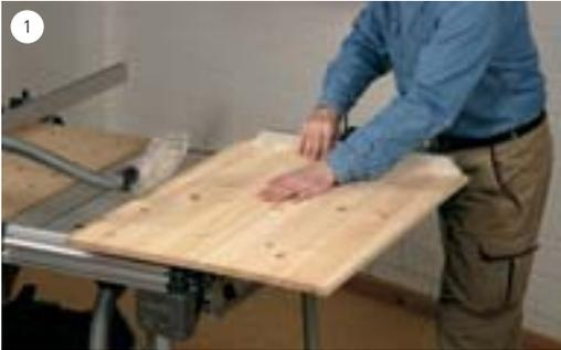
**1** Plattenkante besäumen: Ein Zuschnitt beginnt immer damit, eine Plattenkante ganz gerade zu sägen. Dabei ist darauf zu achten, dass sich die Platte während des Sägevorganges nicht verschiebt.
