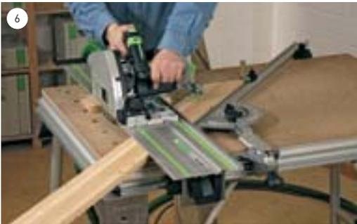
Anschließend die zweite Gehrung bzw. das Rahmenholz auf Länge sägen.
