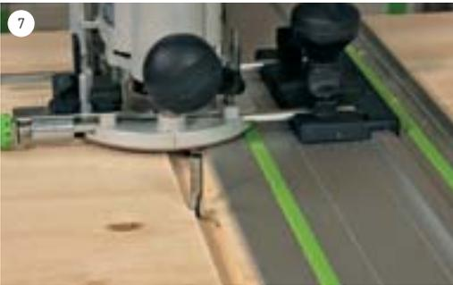
7 Die Fräse mithilfe der Führungsstangen seitlich verstellen und nacheinander beide geraden Nutflanken mit dem Gratnutfräser auf 15° abschrägen.
