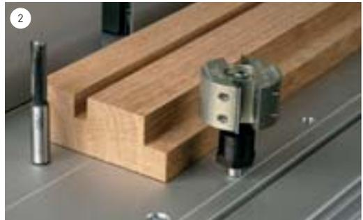
Mit einem Nutfräser (links) können Sie zwar auch falzen, der größere Falzfräser (rechts) fräst aber mit höherer Schnittgeschwindigkeit und durchtrennt die Fasern in flacherem Winkel.
