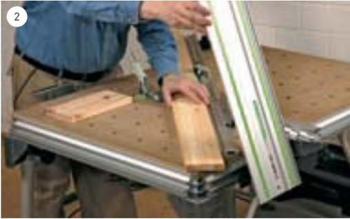
Legen Sie das Rahmenholz an den Anschlag und ein weiteres Restholz gleicher Dicke als Stütze unter die Schiene.
