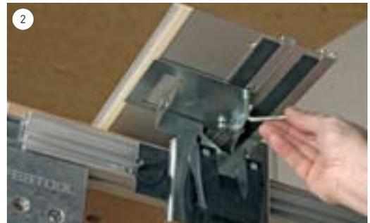
Lassen Sie die Schiene einige Zentimeter überstehen und ziehen Sie beide Schrauben wieder gut fest.
