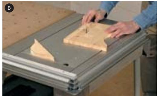
Dank perfekter Sicht auf Sägeblatt und Schnittverlauf können geschwungene Werkstücke mit dem Modulträger für die Stichsäge noch präziser gesägt werden.
