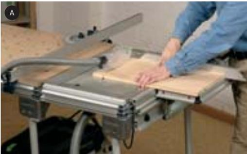
Mit dem Sägemodul und der Tauchsäge TS 55 wird aus dem MFT 3 eine vollwertige Tischkreissäge mit Schiebetisch, der an die MFT 3-Verlängerung montiert werden kann.
