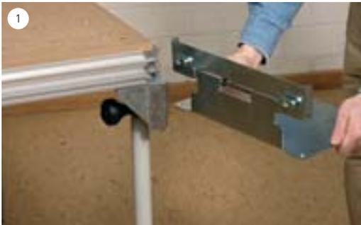
Die Spanneinheit des Vakuum-Spannsystems wird mittels einer Adapterplatte mit dem MFT 3 verbunden, die in das Tischprofil des MFT 3 geschoben wird.
