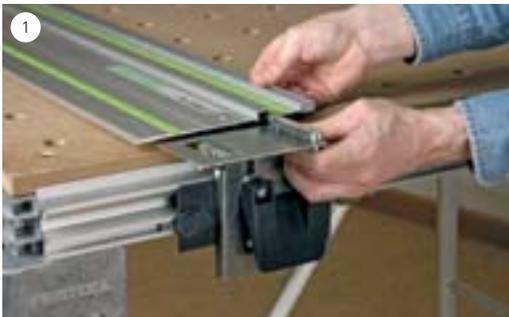
Lösen Sie die beiden Schrauben in der Schwenkeinheit und schieben Sie die Führungsschiene auf die Passfeder.
