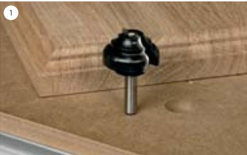
Je nach Brettstärke wird ein mehr oder weniger stark profilierter Fräser in die Maschine gespannt.
