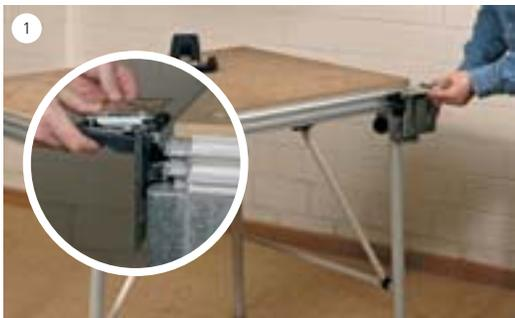
Schieben Sie die Schwenkeinheit am Längsprofil des Tisches mit der Kunststoffeiste in das Tischprofil ein.
