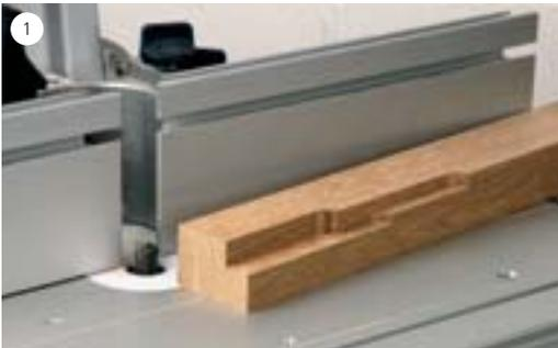
Falzen und Nuten von Leisten ist auf einem Frästisch präziser und sicherer als mit der handgeführten Oberfräse. Große Falze immer in mehreren Arbeitsgängen herausfräsen: das schont den Fräser und verringert den Holzaustriss.
