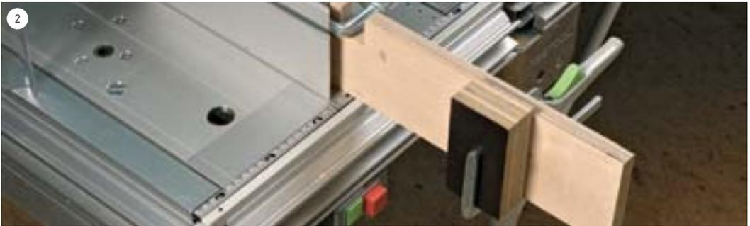
Bei längeren Werkstücken können die Brettchen nicht am Anschlag befestigt werden. Hier hilft eine Verlängerung aus Multiplex: am Anschlag befestigen, Brettchen daran fixieren.
