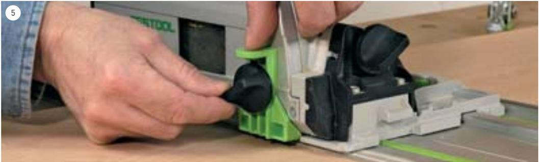
Für beidseitig austrissfreie Schnitte montieren Sie den Splitterschutz an die Tauchsäge, senken diesen auf Ihr Werkstück ab, fixieren ihn und sägen ihn langsam ein.
