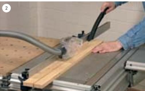
Sollen besonders schmale Leisten zugeschnitten werden, muss das Alulineal am Anschlag in eine flache Position gebracht werden, ...
