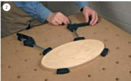
Das Werkstück zwischen die Spannelemente legen, den beweglichen Spannkopf gegen die Kante schieben und den Hebelgriff nach hinten festziehen.
