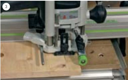
Die Gratnut soll ca. 3 cm vor der Kante enden. Auch dieses Maß mit dem Bleistift markieren und die Maschine so verschieben, dass der Strich mit der „0“ auf der Skala der Abstützung übereinstimmt.
