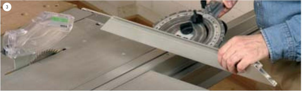
Winkelanschlag montieren: Der Winkelanschlag kann wie hier gezeigt, vorne oder hinten in den Schiebeschlitten eingehängt werden. Achtung: Das Anschlaglineal darf nicht über den Alutisch schleifen!
