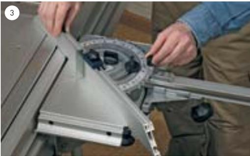
**Winkelschräge einstellen:** Zum Schluss wird der gewünschte Winkel mithilfe der Skala am Anschlag eingestellt. Bei den wichtigsten Winkeln rastet ein Stift in die Skala ein.
