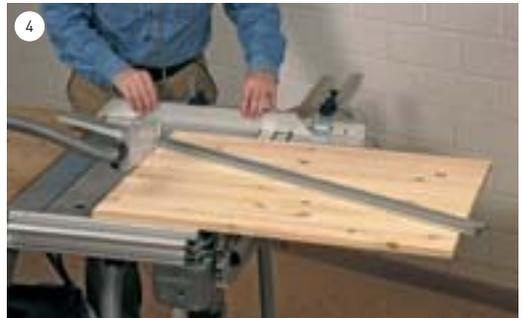
**4** Um eine möglichst hohe Wiederholgenauigkeit bei den Zuschnitten zu erzielen, ist der klappbare Anschlagreiter eine große Hilfe.
