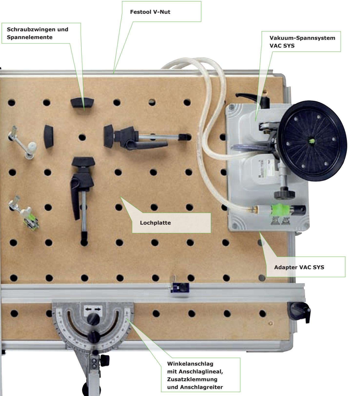
Schraubzwingen und Spannelemente
