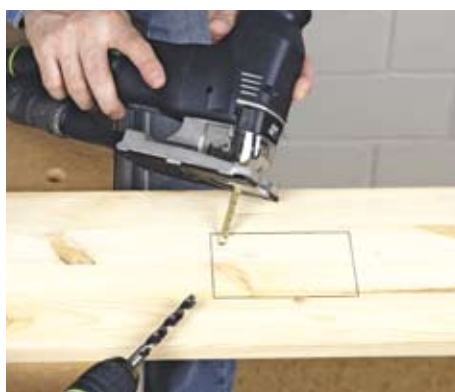
Eintauchen mit Vorbohren
