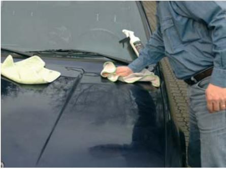
1. Gründliches Reinigen der Flächen mit Wasser und einer Reinigungsmittelzugabe ohne Wachsanteil. Danach müssen Sie die Fläche trocknen ("abledern"). Da eine Berührung der Kunststoffteile mit dem Polierschwamm immer vorkommen kann, behandeln Sie diese Teile zuvor mit einem Kunststoffpflegemittel.
