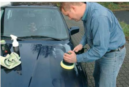
ROTEX auf Stufe 1. Verteilen Sie die Polierpaste auf der Fläche und steigern Sie dann die Drehzahl auf Stufe 6. Legen Sie die Maschine plan auf und
