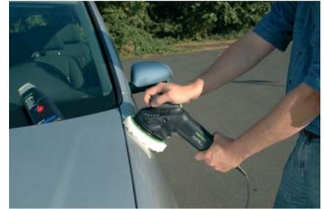
**Abnehmbarer Absaugkanal:** Wenn Sie polieren wollen, brauchen Sie keine Absaugung. Praktisch, dass man beim RO 150 den Absaugkanal mit einem Handgriff einfach abnehmen kann. So sparen Sie Gewicht und können ungehindert polieren.
