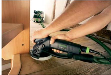
**PROTECTOR:** Beim Schleifen traut man sich oft nicht so recht an rechtwinklige Stoßkanten heran, um den Schleifteller nicht zu beschädigen. Mit dem PROTECTOR ist das kein Problem mehr, denn er schützt Werkstück und Schleifteller, auch wenn Sie bis an den Rand schleifen. Kurz: ein besseres Ergebnis mit weniger Nacharbeit.
