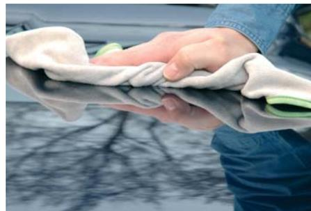
feiner auspolieren. Die Vorgehensweise ist die gleiche wie zuvor beschrieben, reinigen Sie auch hier abschließend die Fläche wieder mit einem Microfasertuch.
