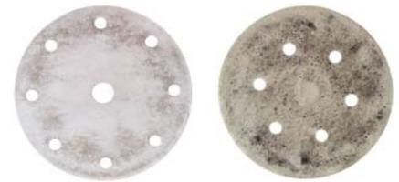
*Weniger Zusetzen:* Bei Wärme verklumpen die Staubpartikel. Das Schleifmittel setzt sich zu und ist schnell nicht mehr zu gebrauchen. Durch die bei Jetstream niedrigere Temperatur wird das Zusetzen deutlich verringert.
