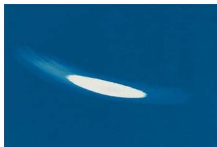
**Tellerbremse:** Bestimmt ist Ihnen das auch schon einmal passiert: beim ungenauen Aufsetzen einer Schleifmaschine auf ein Werkstück wird die Oberfläche beschädigt (siehe Bild). Der RO 150 hat eine so genannte Tellerbremse, die verhindert, dass der Schleifteller im Leerlauf hochdreht und so Schäden beim Aufsetzen verursacht.
