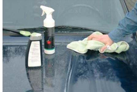
3. Wischen Sie alle Polierrückstände mit dem grünen Microfasertuch ab und reinigen Sie die Fläche mit dem passenden Reinigungsmittel. Alternativ zum groben Schwamm können Sie auch ein Lammfell benutzen.
