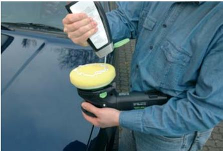
2. Stellen Sie das ROTEX-Getriebe auf die Rotationsexzenterstellung (Grob-schliff). Montieren Sie den Polierteller auf der Maschine und befestigen Sie einen groben Polierschwamm (gelb) darauf. Bringen Sie gleichmäßig die Polierpaste (Körnung 6.000) auf den Teller auf und reduzieren Sie die Drehzahl des
