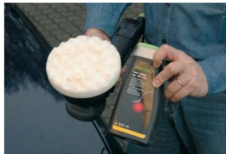
4. Um eine dauerhafte Fläche zu bekommen, müssen Sie in einem zweiten Poliergang mit einem feinen Schwamm und Polierpaste (Körnung 10.000) die Fläche
