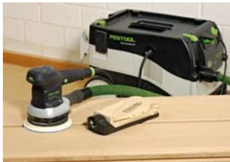
**Immer mit aktiver Staubabsaugung** schleifen anstelle des einfachen Staubsacks. Denn der Sauger hält die Fläche frei von Staub und ausgebrochenen Schleifkörnern und erhöht somit die Standzeit des Schleifpapiers um ein Vielfaches.
