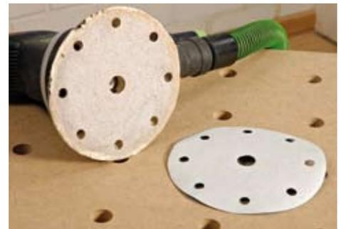
**Stumpfes Papier** frühzeitig wechseln sonst werden durch „eingebraunte“ Holzfasern und Staub nur zusätzliche Riefen in die Oberfläche geschliffen. Wichtig: Mit geringem Druck, vollflächig und nicht mit den Kanten des Schleiftellers arbeiten!
