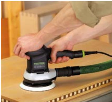
**Der ideale Einstieg:** Egal ob Holz- oder Lackschliff, der 150er Schleifteller mit 3 mm Schleifhub ist für die meisten Anwendungen des Holzwerkers genau das Richtige.
