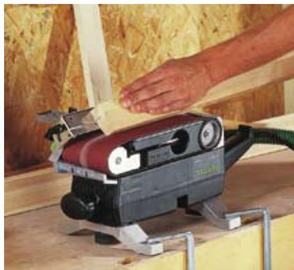
**Stationäres Schleifen:** Mit dem Winkelanschlag wird aus dem Bandschleifer im Handumdrehen eine kleine stationäre Schleifmaschine für schmale Leisten.
