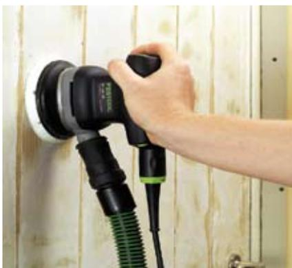
**Einhand-Schleifen:** Das kleinere und handlichere Modell mit 125er Schleifteller ist mit 2 mm Schleifhub nicht ganz so leistungsfähig wie die größeren Modelle mit 3 bzw. 5 mm.
