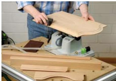
**Teile vor dem Zusammenbau schleifen** wie z. B. Profile von Füllungen und Rahmen, die man nach dem Verleimen nur mühsam erreicht. Aber auch die Flächen sollten vorher geschliffen werden. Später reicht ein leichter Schliff von Hand aus.
