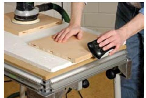
**Eine Styroporunterlage** schützt z. B. das dünne Furnier von Tischlerplatten vor Dellen und Kratzer durch eingedrückte Späne, die auf der harten Oberfläche des Werkzeugs liegen können.
