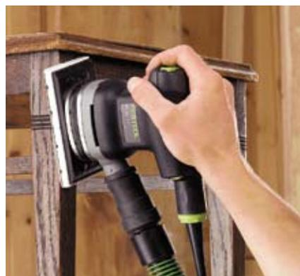
**Leichtgewicht:** Ein leichter und handlicher Schwingschleifer ist besonders dann zu empfehlen, wenn häufig an senkrechten Flächen oder über Kopf geschliffen werden muss.
