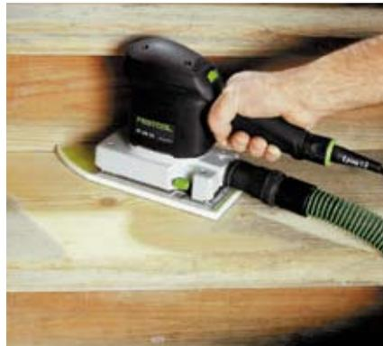
**Randnahes Schleifen:** Durch einen Spezialschleifschuh sind auch schwer zugängliche Stellen im Treppenbereich oder bei Lamellentüren gut erreichbar.
