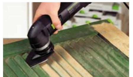
**Wenn's ganz eng wird:** Der Dreieckschleifer kommt mit seinem Lamellen-Schleifschuh nicht nur in Eckbereiche, sondern auch sehr schmale Zwischenräume.
